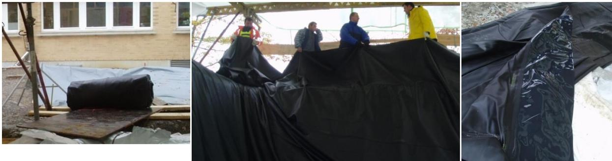
**Bild 17: EPDM im Außenlabor: Links, Lieferung als vorgefertigte Plane, Mitte: ausbreiten im Außenlabor, rechts Fügerand mit dem das Verschweißen ermöglicht wird.**
