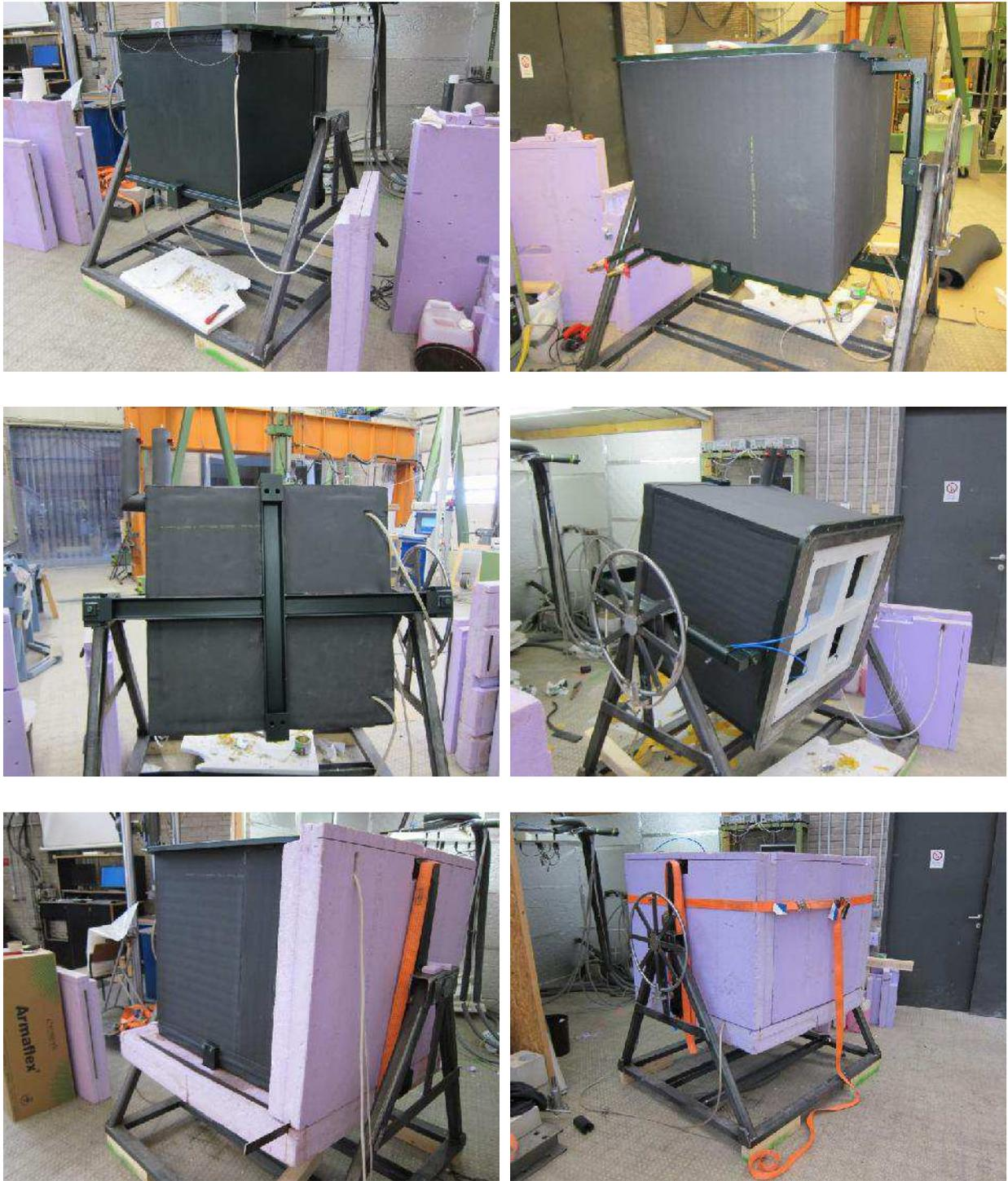
Abbildung 22: Erweiterung der Ein-Plattenapparatur – Dreheinrichtung
