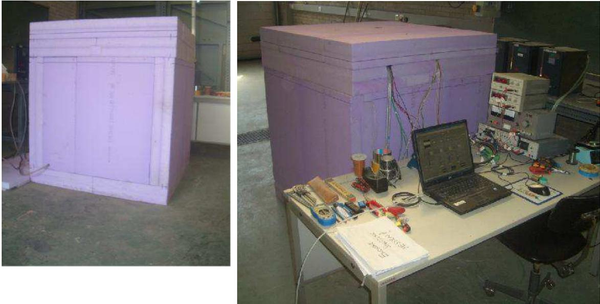
*Abbildung 20: Fotos der Apparatur in gedämmtem Zustand*
