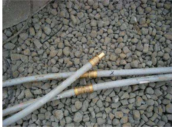
Abbildung 1 Glasschaumschotter, Wärmespeicher in Craislheim, Quelle: ITW
