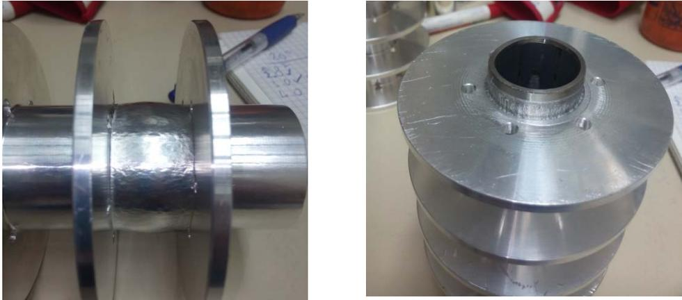
**Abbildung 18: Deformationen an den Aluminiumproben der Variante 4**
