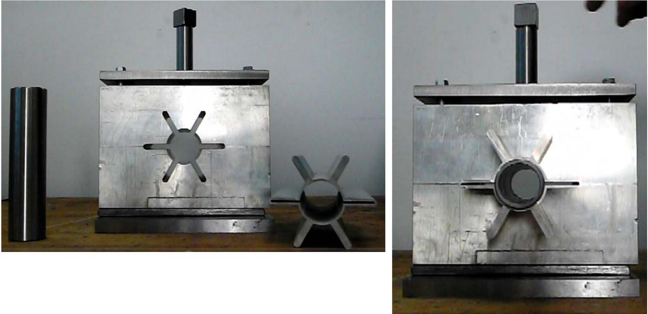
**Abbildung 23: Bimetall-Rippenrohr vor und nach der Fertigung**
