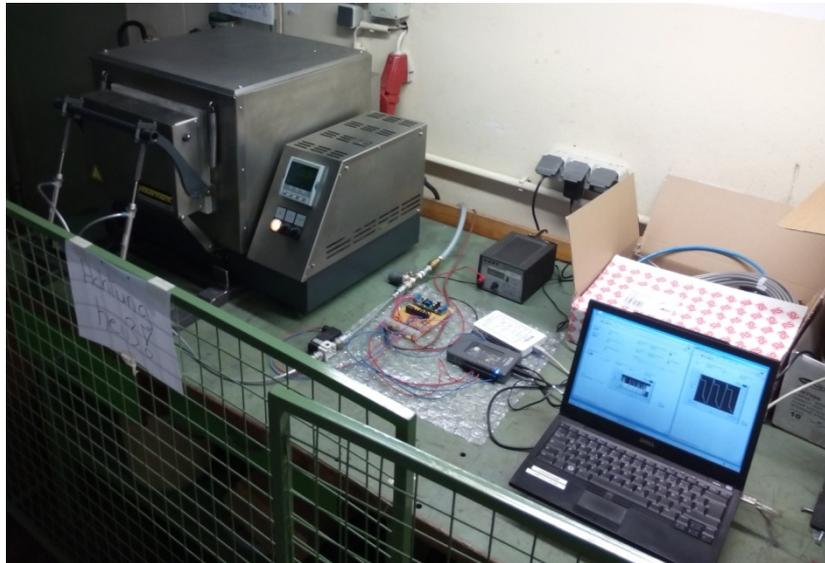
**Abbildung 11: Muffelofen mit Öffnungsvorrichtung und Steuerung**
