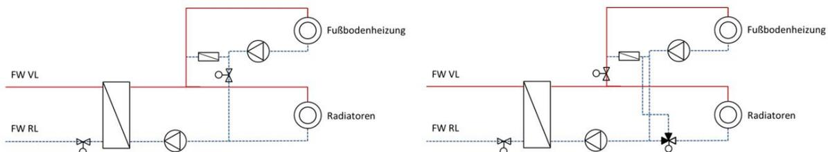
Abbildung 10: Vereinfachtes Hydraulikschema einer Übergabestation (links) und mit kaskadischer Nutzung (rechts) [1]
