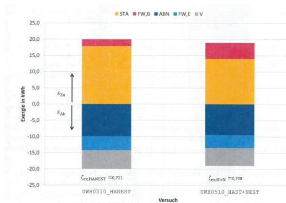
**Abbildung 40 Exergetischer Vergleich der Messergebnisse für HANEST und HAST+NEST (Quelle: Rühling et al. 2015)**
