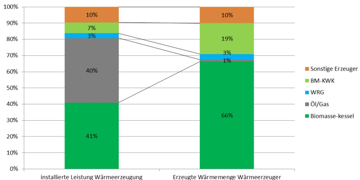
Abbildung 18: Anteile der installierten Leistung und der erzeugten Wärmeenergie der unterschiedlichen Wärmeerzeuger in Biomasse-Netzen [7]
