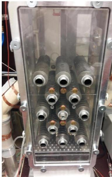
Abbildung 16: Prüfstand mit Rippenrohre, versetzt und ohne Bettmaterial
