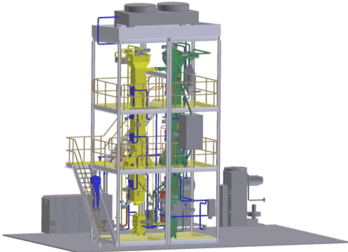
Abbildung 29: 3D-Schema der TSA-Pilotanlage (gelb: Adsorber; grün: Desorber; blau: Kühl-/Heizwasser)
