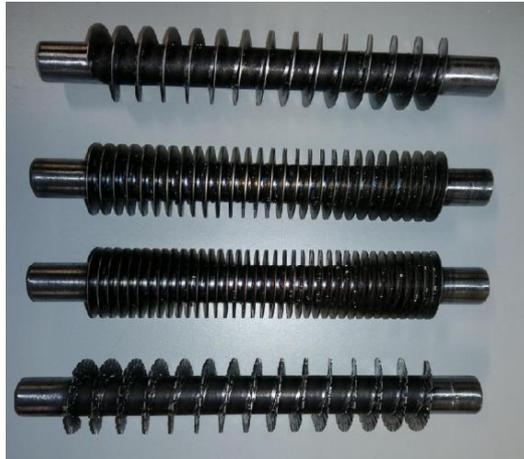
Abbildung 14: Rippenrohre mit unterschiedlicher Rippenteilung und eines mit segmentierten Rippen
