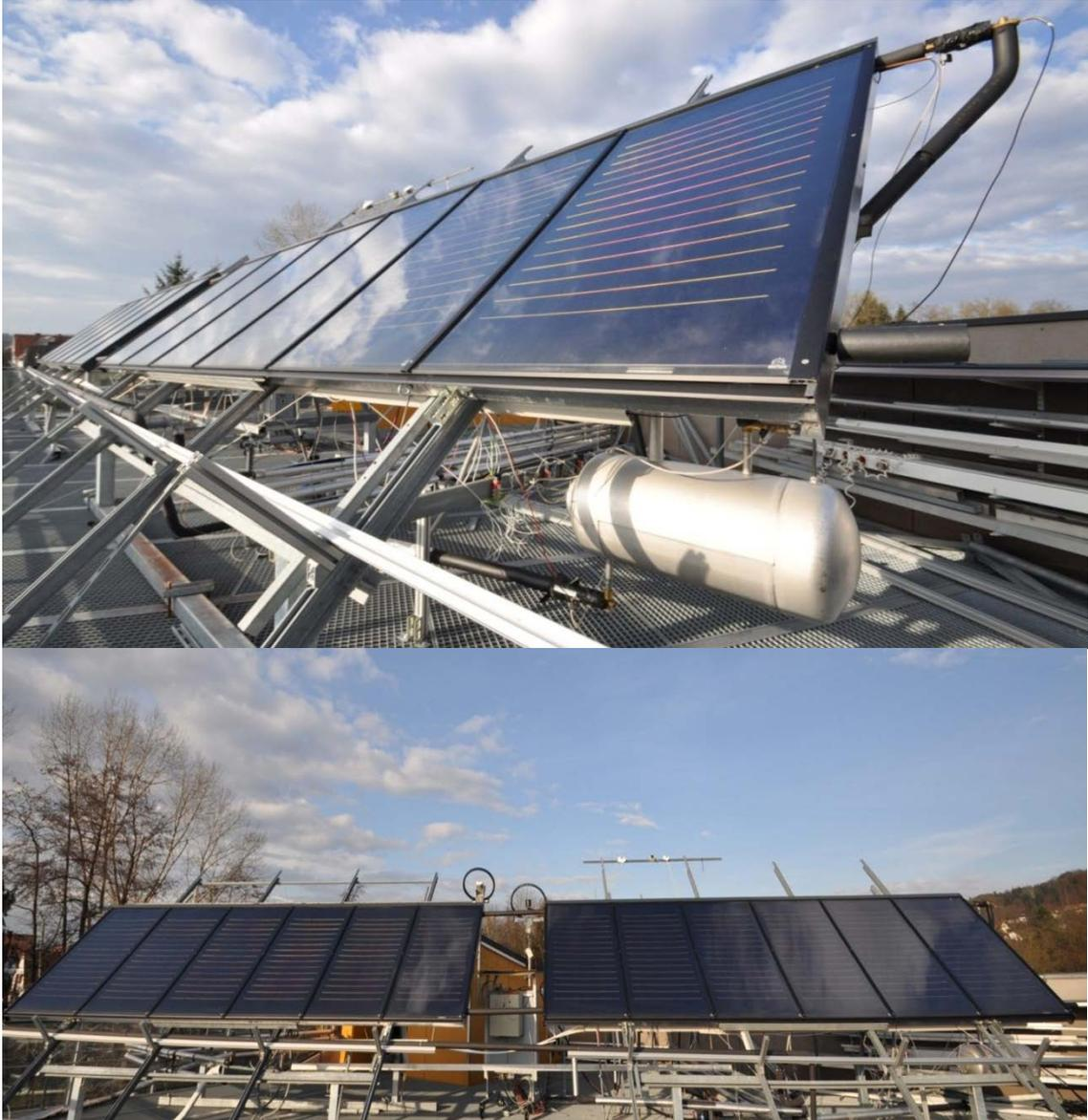
*Abbildung 35: Ansicht des 25 m<sup>2</sup> großen Kollektorfeldes - und des Entleerbehälters (Verschaltung 1, Mäanderabsorber) am Prüfstand von AEE INTEC*
