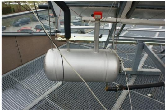
Abbildung 22: Darstellung der in den Labortests in Verbindung mit den 25 m<sup>2</sup> großen Kollektorflächen eingesetzten Entleereinheit inkl. hydraulischer Anschlüsse und Messtechnikdetails.
