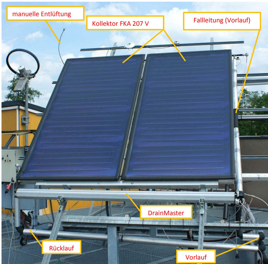
Abbildung 64: Aufbau Kollektoren und DrainMaster am Teststand der AEE INTEC
