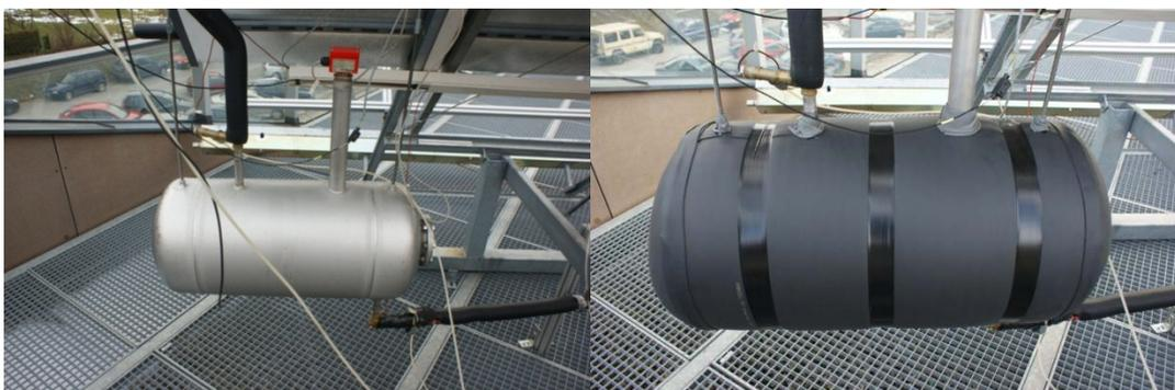
Abbildung 34: Ansicht der in den Labortests in Verbindung mit den 25 m<sup>2</sup> großen Kollektorflächen eingesetzten Entleereinheit (ungedämmt und gedämmt) mit Füllstandssensor (rot)
