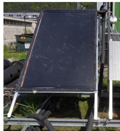
**Abb. 1-2:** Design eines dachintegrierten, eigentemperatursicheren Kunststoffkollektors (links) und Modell-Kollektor der Serie 2 am Prüfstand (rechts).
