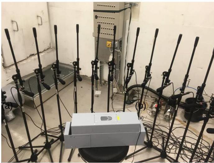
Abbildung 34: (links) ANC Rechteckskanal im einem 16 Kanal Mikrophon Halbkreis zur Bestimmung der orts aufgelösten Schallreduktion; (rechts) 300 mm kreisförmige Variante
