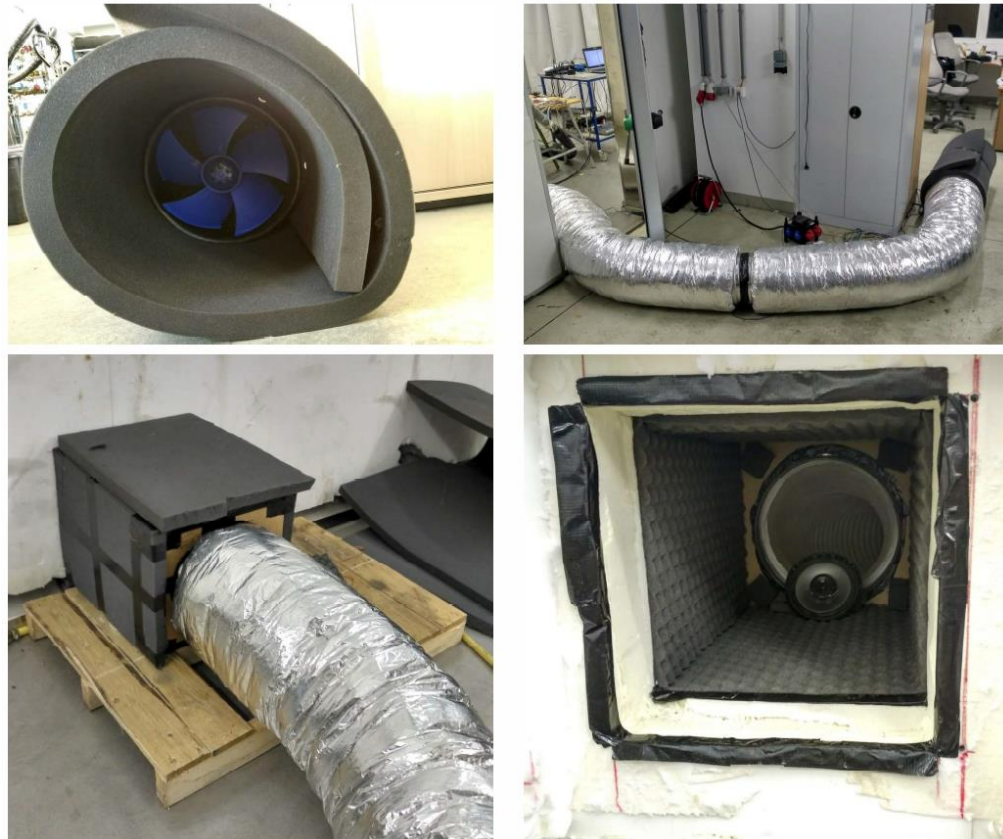
Abbildung 40: Versuchsaufbau für Messungen der Transmissionseigenschaften von WT und Dämm-Materialien in saugender und drückender Strömung (Schematik siehe Abbildung 38 rechts).
