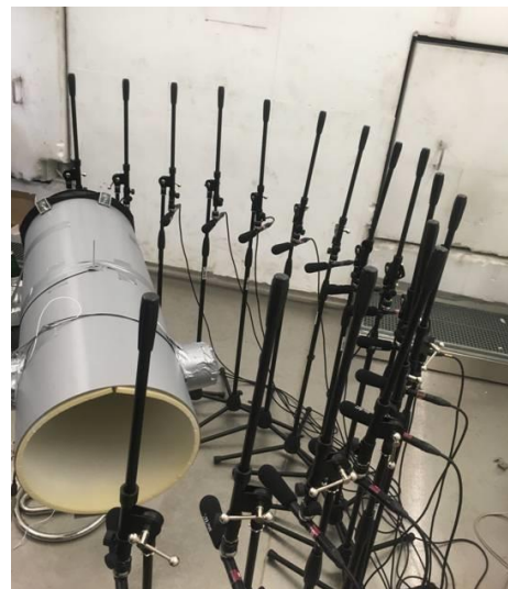
Abbildung 34: (links) ANC Rechteckskanal im einem 16 Kanal Mikrophon Halbkreis zur Bestimmung der orts aufgelösten Schallreduktion; (rechts) 300 mm kreisförmige Variante
