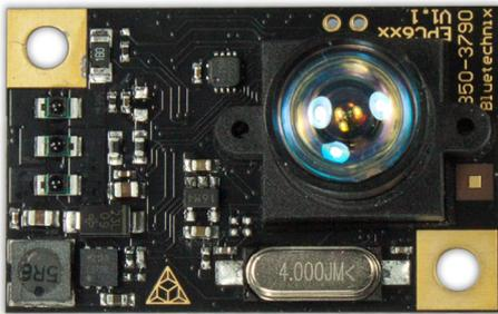
Abbildung 2: Bild des epc610 Sensormoduls
