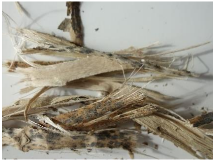
Abbildung 17: Bast / Faseranteil S. hermaphrodita M1:3 (Bildquelle: Holzforschung Austria)
