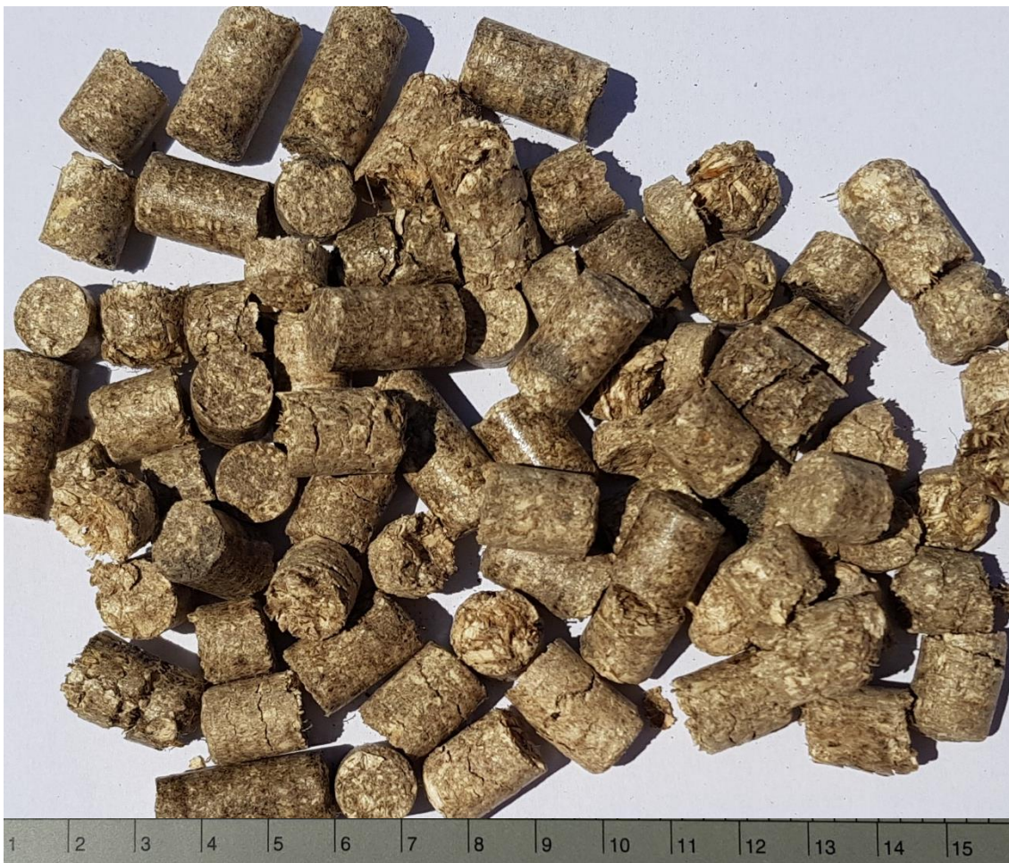
Abbildung 28: S. hermaphrodita Pellets aus der mobilen Pelletierung (M 1:1)
