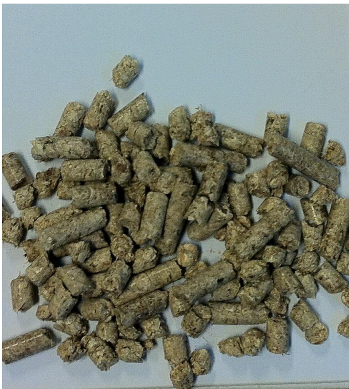
Abbildung 26: Pellets aus Versuch 473016 M1:1,5 Bild 14: Pellets aus Versuch 473016 M1:1,5 (Bildquelle: Holzforschung Austria)
