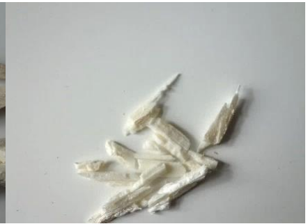
Abbildung 19: Markanteil S. hermaphrodita M 1:3 (Bildquelle: Holzforschung Austria)
