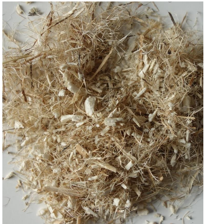
Abbildung 21: gemahlen mit Hammermühle Sieb 14 mm M1:1,5 (Bildquelle: Holzforschung Austria)
