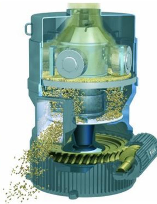
Abbildung 3: Flachmatrizenpresse Kahl 33-390 mit Rohstoffzufuhr (Bildquelle: Holzforschung Austria), rechts: schematisches Funktionsprinzip, entspricht Kollermühle (Bildquelle: A. Kahl)
