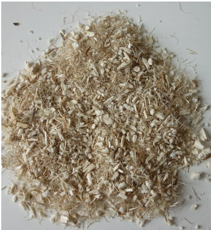
Abbildung 22: gemahlen mit Hammermühle Sieb 7 mm M1:1,5 (Bildquelle: Holzforschung Austria)
