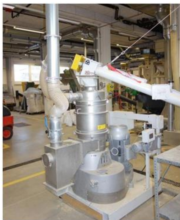
Abbildung 3: Flachmatrizenpresse Kahl 33-390 mit Rohstoffzufuhr (Bildquelle: Holzforschung Austria), rechts: schematisches Funktionsprinzip, entspricht Kollermühle (Bildquelle: A. Kahl)
