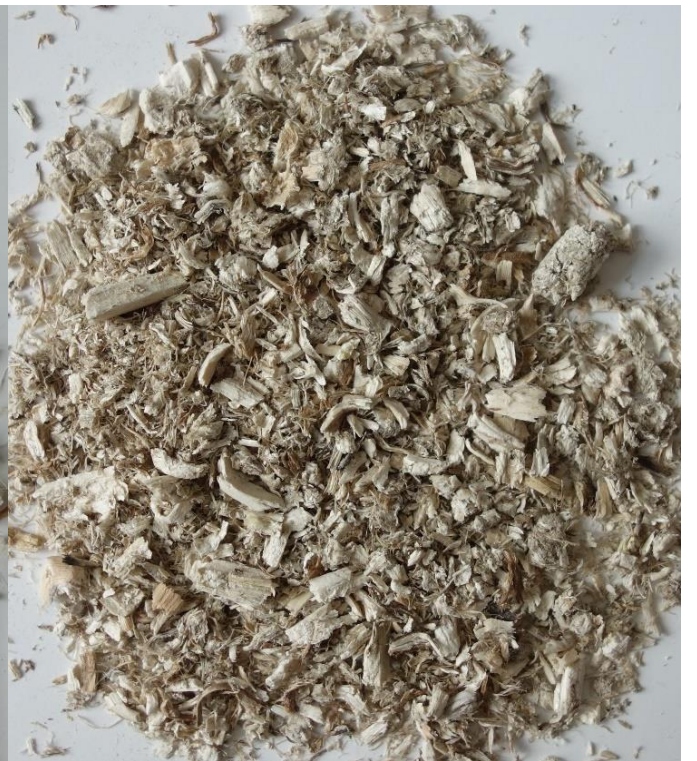
Abbildung 23: gemahlen mit Kollermühle Matrice 6 mm M1:1,5 (Bildquelle: Holzforschung Austria)
