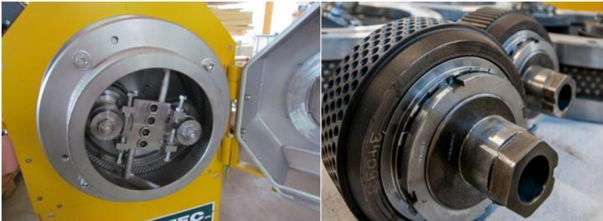
Abbildung 4: Ringmatrizenpresse Salamtec ECO Mini 360 mit geöffneter Pressentüre (links) und Koller gelocht (rechts vorne) sowie geriffelt (rechts hinten) (Bildquelle: Holzforschung Austria).
