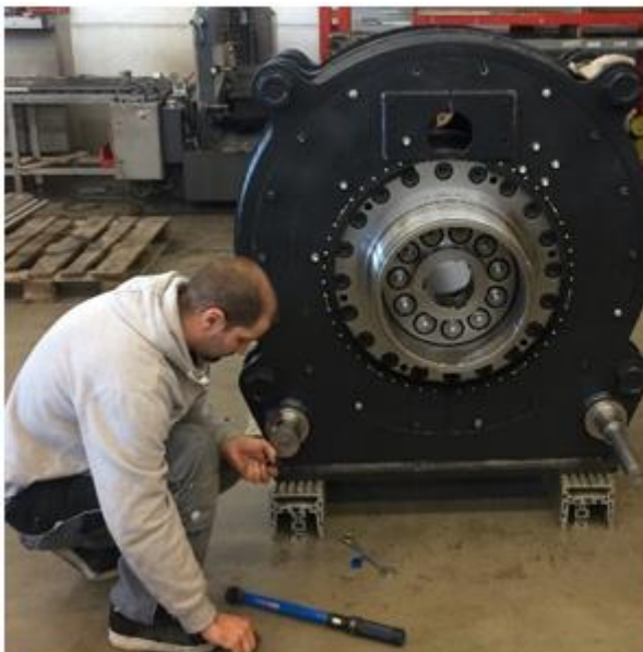
Abbildung 5: Verdichter bei der Vormontage (links), Öffnung für Rohstoffeinfuhr und Ringspalt (rechts) (Bildquelle: Holzforschung Austria)
