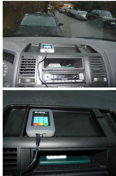
**Abbildung 2.1.3: Positionierung des GPS Gerätes im Pkw**
