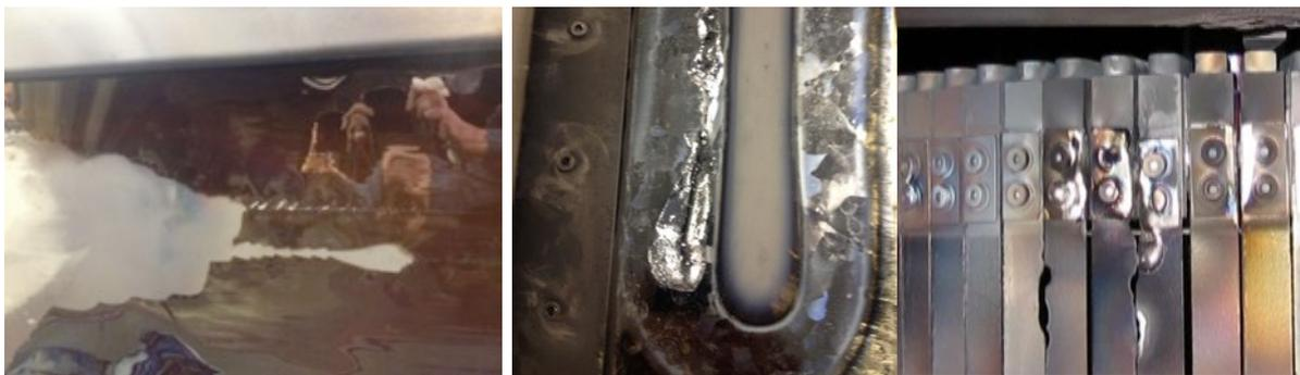
*Der Unterschied zwischen Labor und industrieller Wirklichkeit: Zahlreiche Probleme traten bei der Hochskalierung der komplexen Dünnschicht- und Halbleiterprozesse auf. Das SynerCIS Team war bei der Überleitung in den Rolle-zu-Rolle-Betrieb über weite Strecken des Projekts mit zahlreichen Problemen konfrontiert, die im Laborbetrieb nicht absehbar waren. Die Probleme wie gerissene Substrate, geschmolzene Galliumtargets und Anlagenkomponenten konnten aber nach und nach gelöst werden.*
