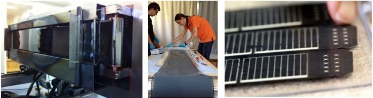
*Abbildungen: Nach Rolle-zu-Rolle-Prozessen zum Auftragen des Mo-Rückkontakts und der CI(G)S-Absorberschicht wird das Material zur Analyse (XRF, SEM, XRD) in kleinere Samples geschnitten. Nach Auswahl der besten Samples werden diese weiterverarbeitet (Buffer-Layer und Frontkontakt-Bschichtung) und anschließend mit einer gedruckten verschaltung versehen und zu fertigen Solarmodulen verarbeitet.*
