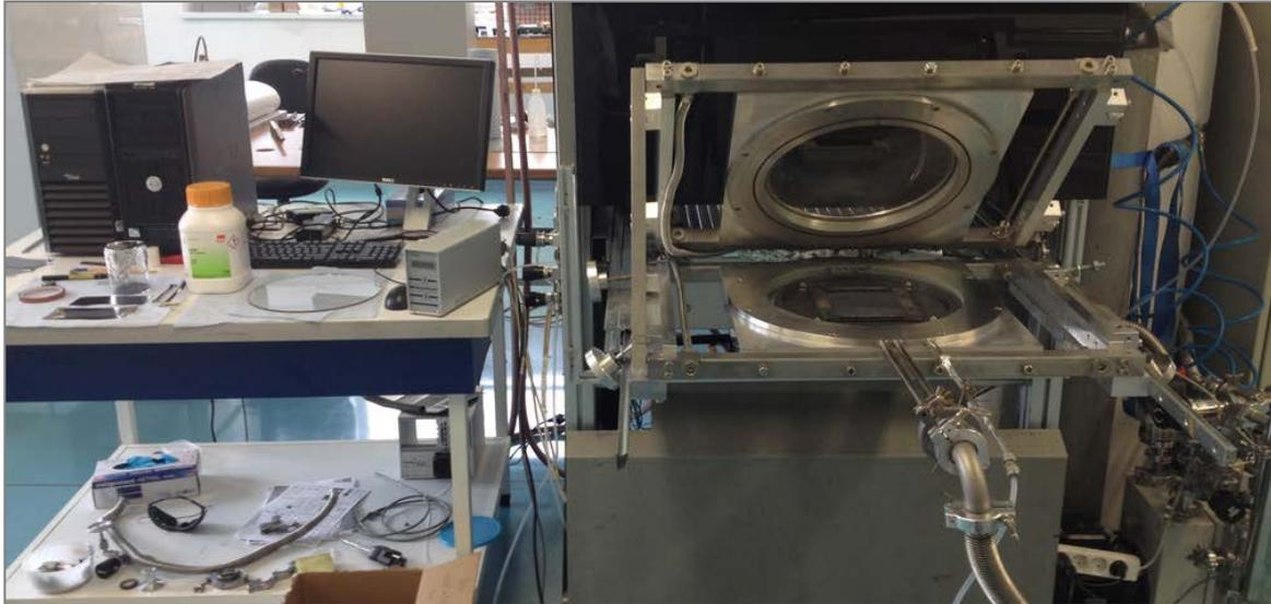
*Der Versuchsaufbau (Vakuum-Ofen) bei Sunplugged für die thermische Nachbehandlung von CIGS Solarzellen. Damit können Solarzellen bis zu einem Durchmesser von 280 mm thermisch nachbehandelt werden. Weiters können unterschiedliche Drücke, Prozessgase und sehr schnelle Aufheiz- und Abkühlrampen gefahren werden.*
