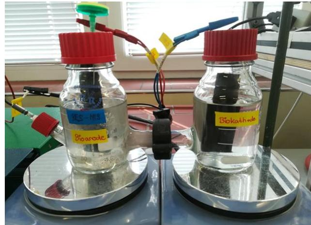
**Abbildung 11: Schematische Darstellung des bioelektrochemischen Systems zur Abwasserreinigung und gleichzeitiger Methanproduktion (links) und aufgebautes System im Labor (rechts).**
