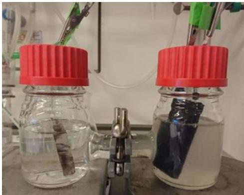
**Abbildung 2: Aufgebaute Zwei-Kammer Zelle für die Etablierung einer Biokathode**
