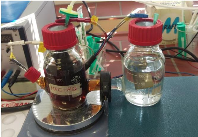
**Abbildung 12: Versuchsaufbau für Tests mit Deponiesickerwasser**
