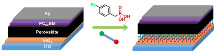
**Abbildung 22.** Schematische Darstellung der Modifizierung der NiO<sub>x</sub>-Schicht mit einer Monolage von BPA-Molekülen.
