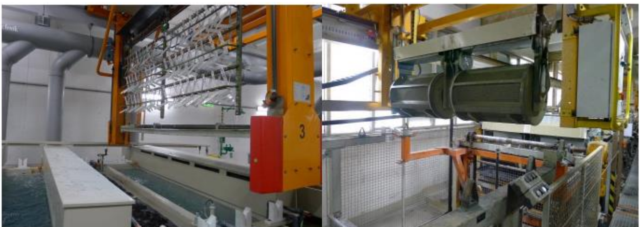
Abbildung 4: Darstellung der galvanischen Prozesse der Roto Frank Austria GmbH – links: Standgalvanik; rechts: Trommelgalvanik (Foto: AEE INTEC)
