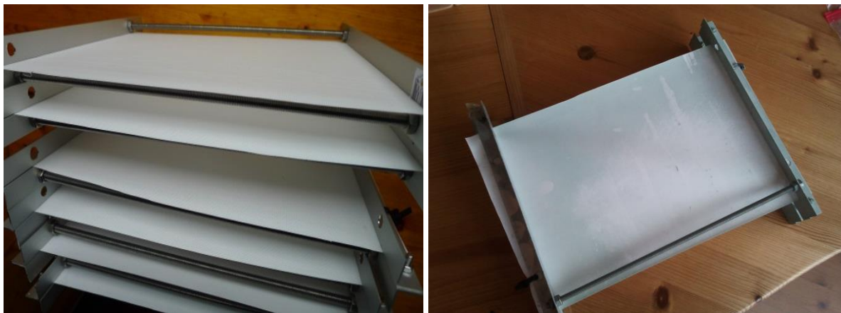
Abbildung 8: Membran neu (links), Membran exponiert (rechts) (Quelle: AEE INTEC)
