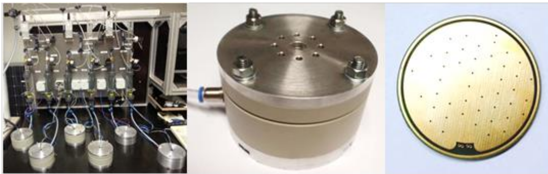
Abbildung 12: LEP Teststation (links); Testzelle (mitte) mit Sensor (rechts). (Fraunhofer ISE)
