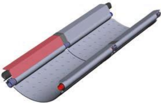
Abbildung 7: Moderne Wärmetauscher (Thermliner Form B Prinzipdarstellung) können auf die Sohle eines bestehenden Kanals montiert werden und dem Abwasser Wärme entziehen; Quelle: UHRIG Kanaltechnik GmbH
