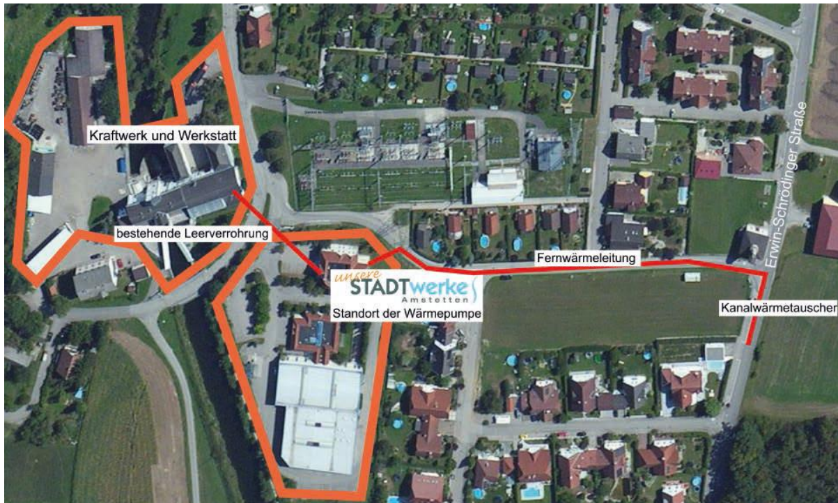
Abbildung 16: Amstetten, ein Projekt zur Wärmenutzung aus dem Kanal mit Vorzeigecharakter, da es auch wirtschaftlich rentabel ist.
