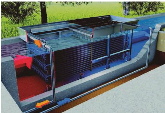
Abbildung 12: Wärmetauscher im Ablaufkanal; Quelle: Huber SE
