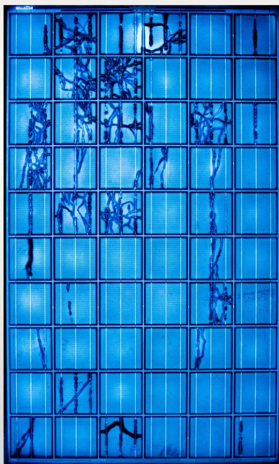
Modul mit typischen Bruchbildern nach Hagel. Das Einkapselungsmaterial enthält wenig Additive und zeigt daher sehr helle Fluoreszenz. Zusätzlich ist eine untypische hohe Helligkeitserhöhung in wärmeren Zellregionen zu erkennen.
