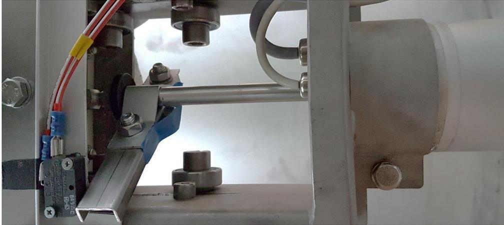
**Abbildung 11: Elektro-Zylinder mit Schieber und Positionsschalter**
