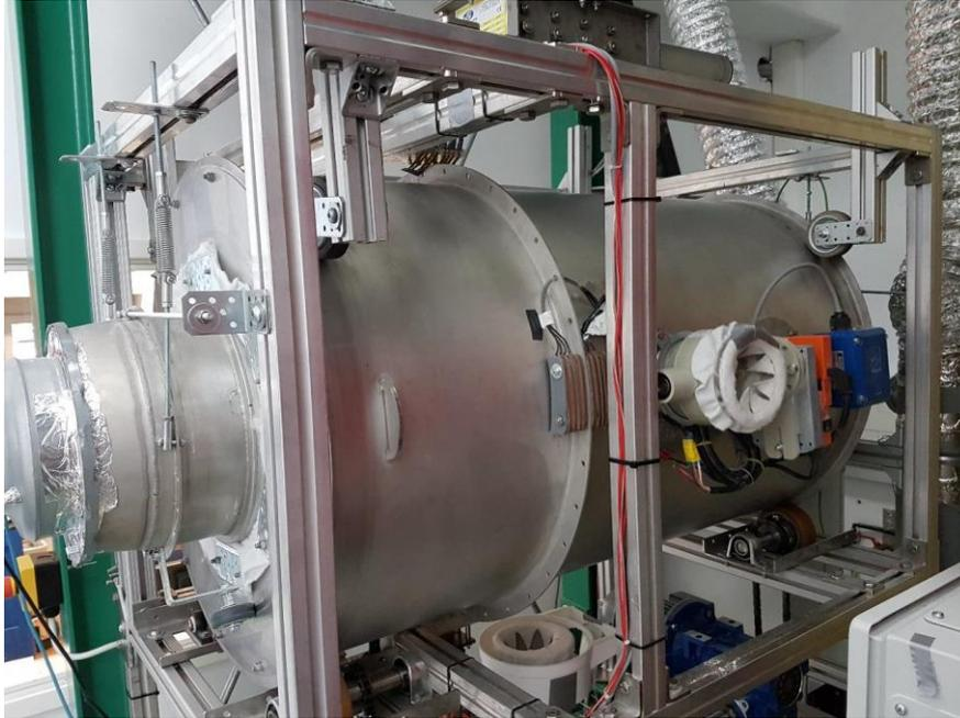
**Abbildung 10: Befeuchtungstrommel mit Absperrklappe und Schleifkontakten**
