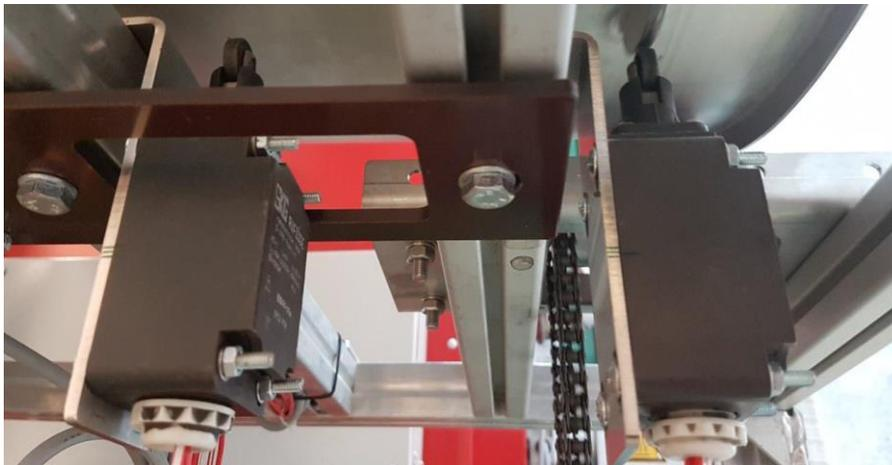
**Abbildung 13: Positionssensoren (Kulissenschalter) für die obere Trommelstellung (links) und die untere Trommelstellung (rechts)**
