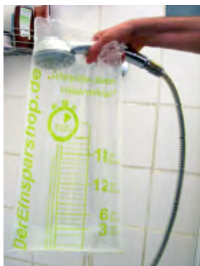
Handhabung des Messsackerls: 10 Sekunden bei maximalem Strahl Wasser einfüllen und den hochgerechneten Wasserdurchfluss für einer Minute ablesen.
