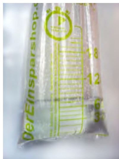
Handhabung des Messsackerls: 10 Sekunden bei maximalem Strahl Wasser einfüllen und den hochgerechneten Wasserdurchfluss für einer Minute ablesen.
