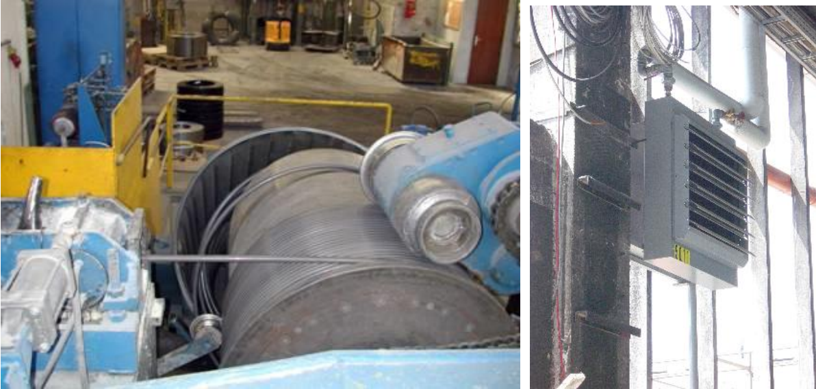
Abbildung 17: Wassergekühlte Ziehmaschinen links und eingesetzte Umluftheizapparate rechts
