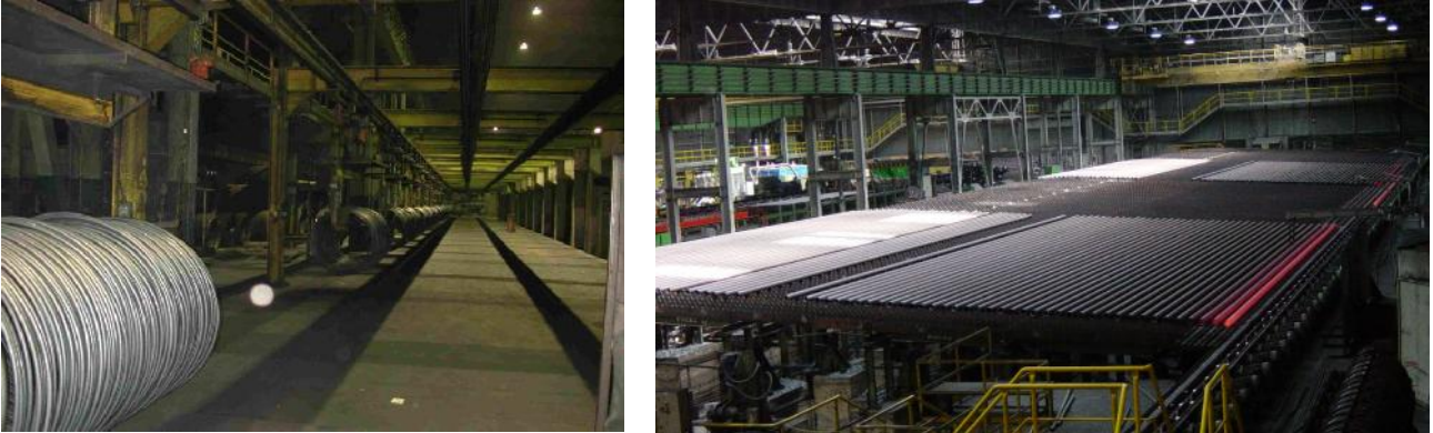
Abbildung 13: Hakenbahn (links) und Kühlbett (rechts)
