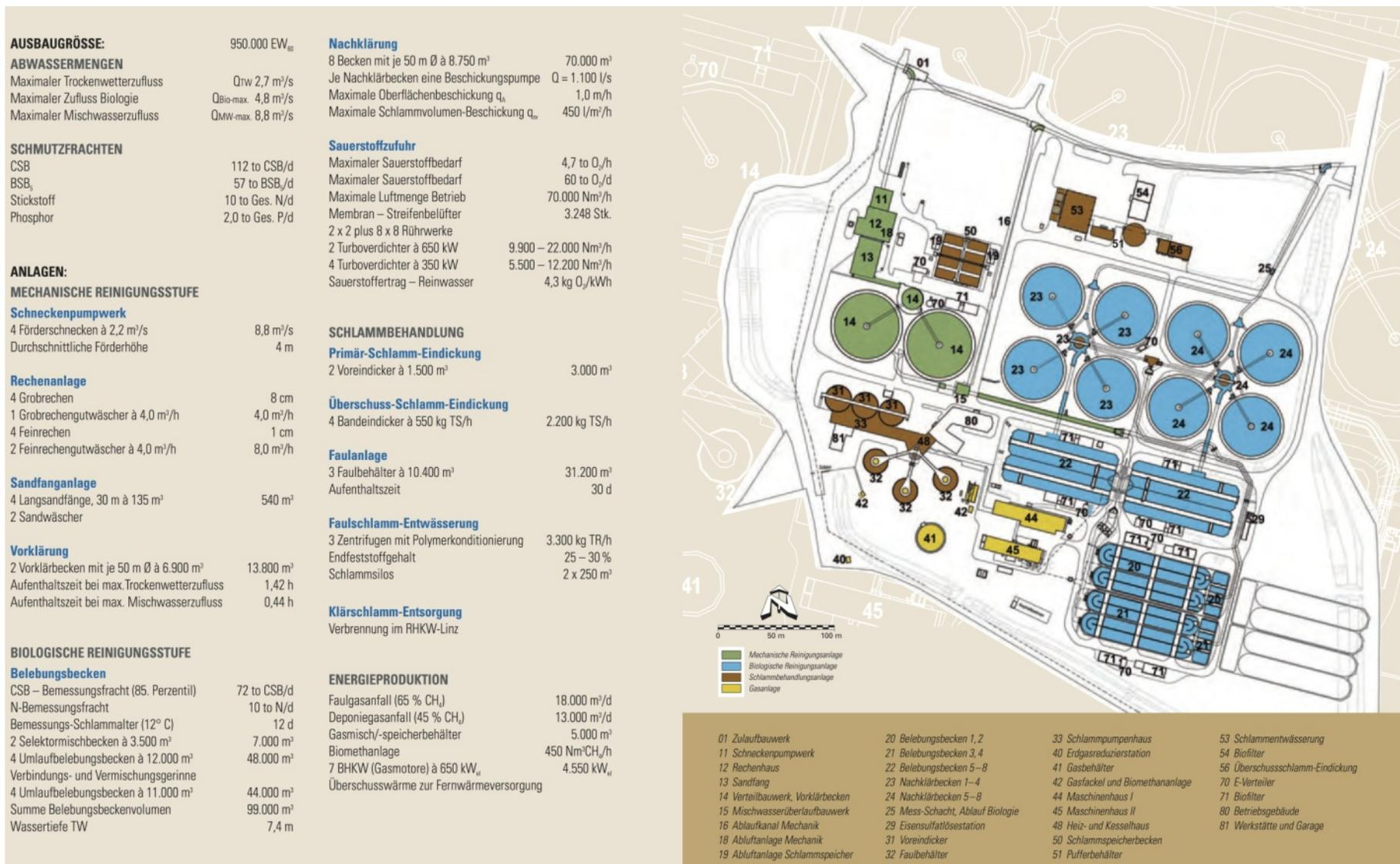
Abbildung 2-8: Anlagenschema – „Kläranlage 2“
