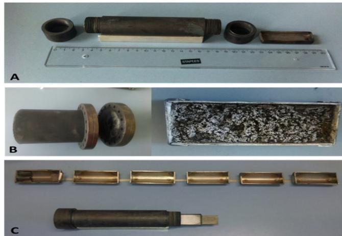
**Abbildung 2: Die verwendeten Reaktionsgefäße für A) einen kleineren Ansatz B) einen größeren Ansatz und C) gleichzeitige Umsetzung mehrerer Chargen.**
