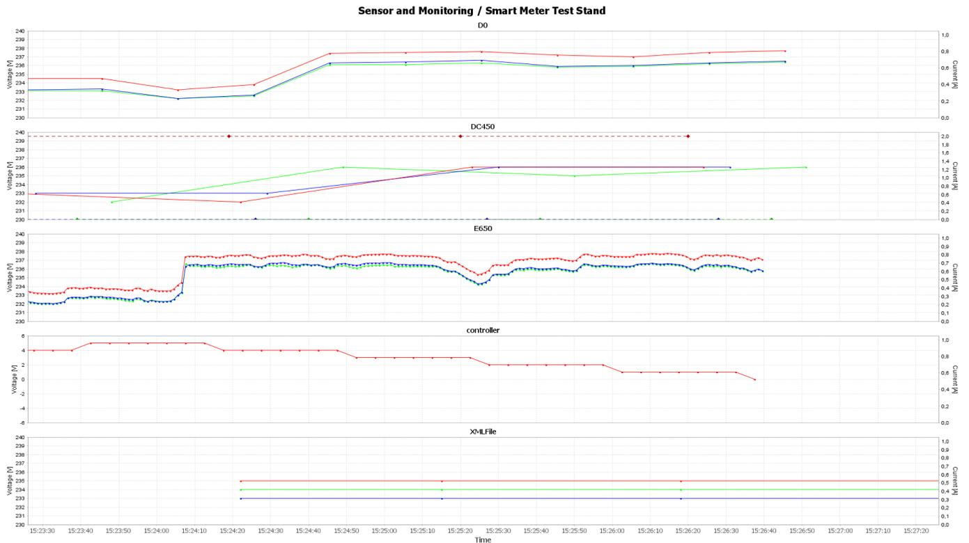
Abbildung 11: SMTS: Dynamische Visualisierung der Reaktionszeiten und Verzögerungen der Spannungsmesswerte auf verschiedenen Zugriffsebenen (SM, DC, MDM).
