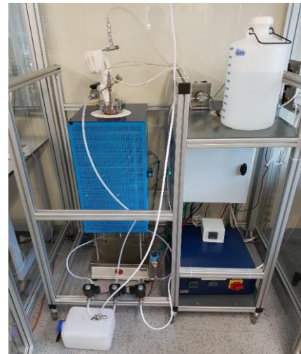
Abbildung 7: Laborteststand für die Ermittlung der Zyklenstabilität einer eisenbasierten Kontaktmasse (Abbildung adaptiert von [8]) Publiziert von Elsevier unter CC BY 4.0
