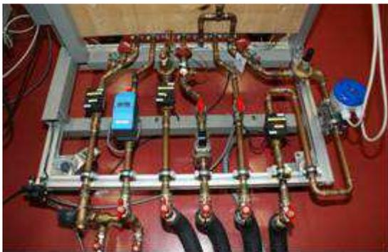
*Abbildung 20: Hydraulische Anspeisung des Prüflings und Volumenstrommessungen*
