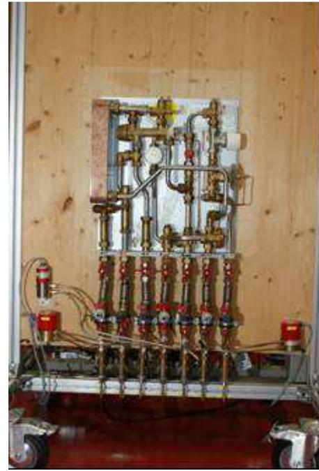
*Abbildung 19: Ansicht des Prüflings inkl. Temperatur- und Differenzdrucksensoren*
