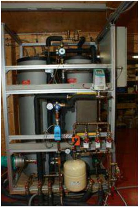
*Abbildung 18: Ansicht Versorgungseinheit und Zapfmengenverteiler*
