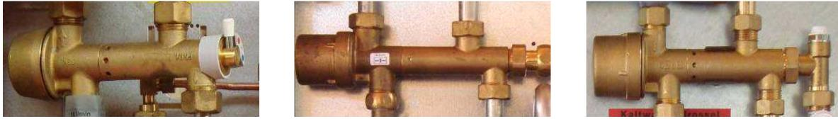
Abbildung 6: Unterschiedliche Ausführungen von Proportionalmengenreglern ohne Temperaturkorrektiv. Das Produkt ganz links ermöglicht Anpassungen bei der Umsetzung der Proportionalmengenregelung über den kleinen Handhebel. Die Produkte in der Mitte und ganz rechts besitzen eine sogenannte „Warmwasservorrangschaltung“.
