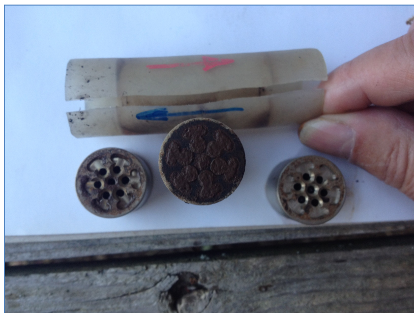
Abbildung 46: Durchflossener Sandsteinplug (Probe OC5/3) mit abgelagerten Feinpartikeln auf der Stirnseite.
