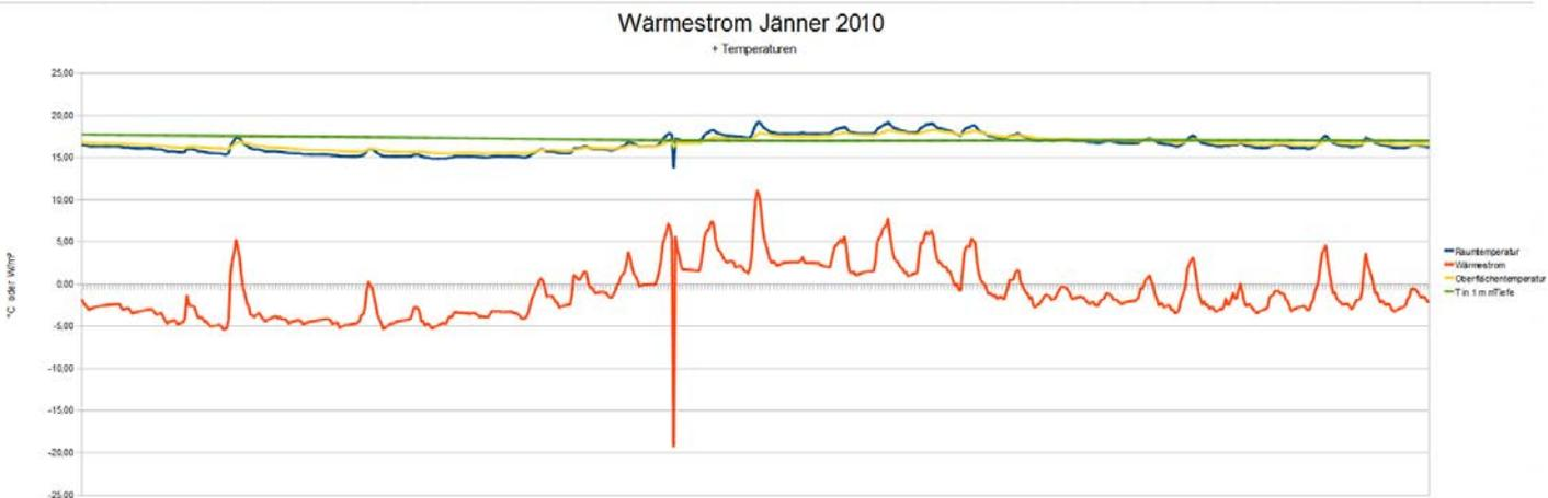
x Achse Zeit, y.-Achse ° Celsius + W/m<sup>2</sup>. Die gemessenen Innentemperaturen wurden als Randbedingung für die Simulation verwendet. Wärmestrom + ist der Strom von
