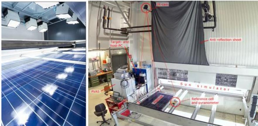
Abb. 32: Links: Blick in den stationären Sonnensimulator am AIT, der auf einer Prüffläche von 9 m<sup>2</sup> 1000 W/m<sup>2</sup> Einstrahlung ermöglicht. Die Module sind in einer Lade angeordnet, die von der klimatisierten Kühlluft durchströmt wird. Rechts: Die Lade im herausgezogenen Zustand. Neben dem Modul ist die Einstrahlungsmessung angeordnet.
