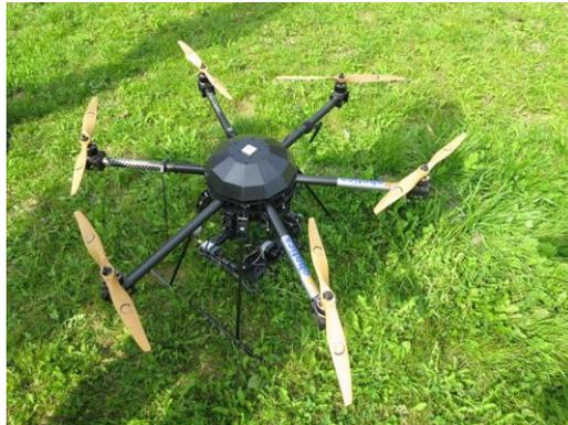
Abb. 12: Die Drohne besitzt ein stabilisiertes Gimbal zur Montage der Kamera.
