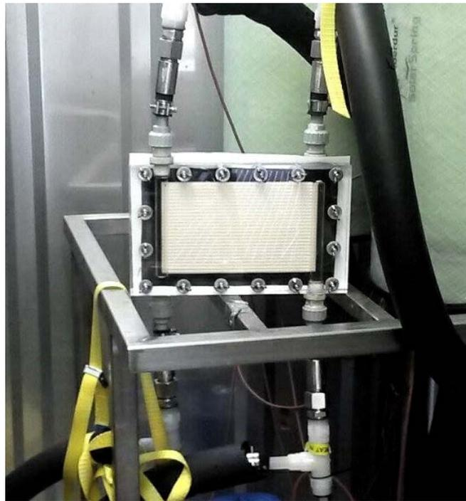
**Abbildung 20: Plattenmodultestzelle in der Technikumsanlage [Quelle AEE INTEC]**
