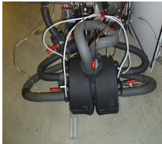
Abbildung 3-1: Foto der Kälteanlage (PinkChiller PC19) mit „DoublePump“ (links) und Detailfoto der „DoublePump“ (rechts)
