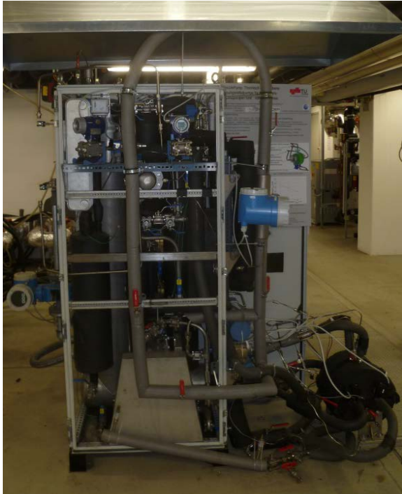
Abbildung 3-1: Foto der Kälteanlage (PinkChiller PC19) mit „DoublePump“ (links) und Detailfoto der „DoublePump“ (rechts)
