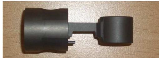
*Pleuel und Kolben final – Belly Band Design*
