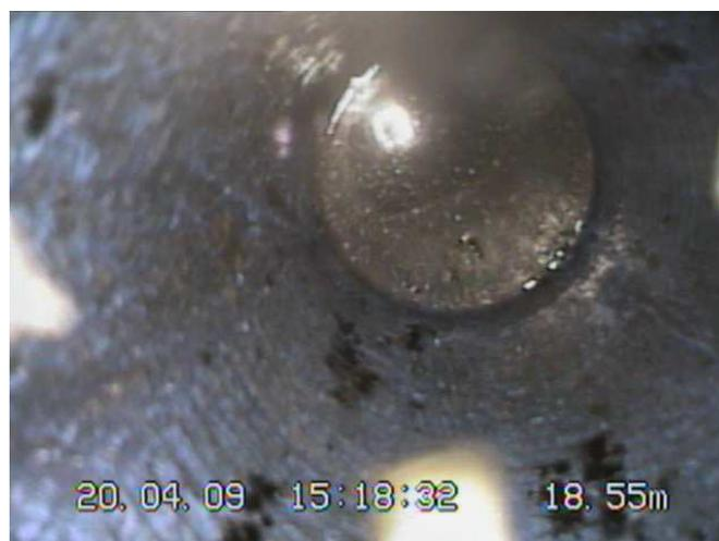
Abbildung 7: Schmutzablagerungen und Ölfilm in der Sonde Gamma
