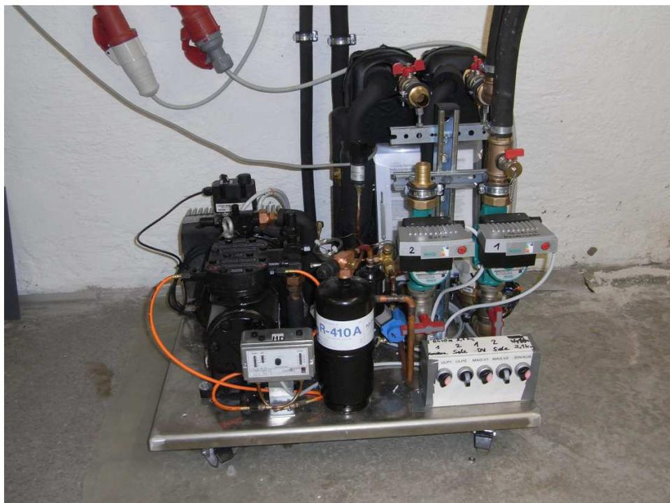
Abbildung 75: Versuchsanlage für DV und Sole mit frequenzgesteuertem Verdichter (2,4 – 6 KW)
