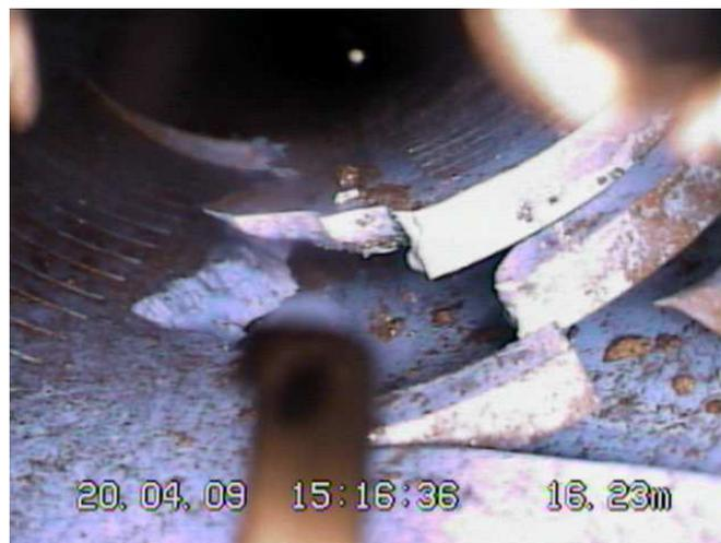
Abbildung 6: Beschädigung der Mantelfläche des Filterrohres in der Sonde Gamma
