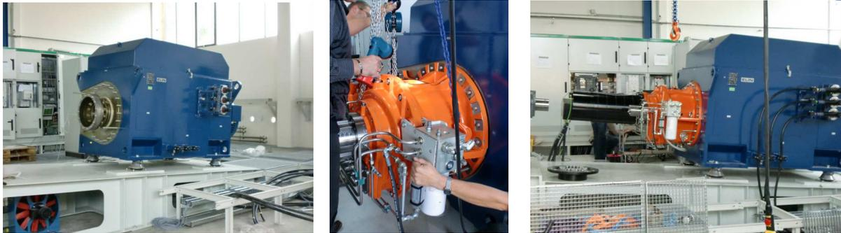
Abbildung 11: Anbau des Synchrongenerator an das Differentialgetriebe
