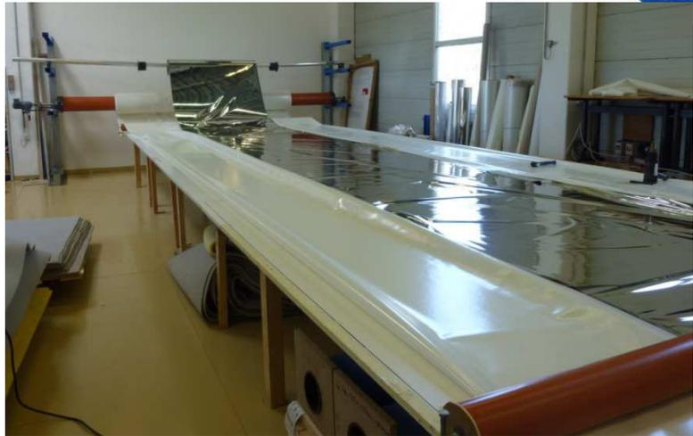
Produktionsschritte: Nähen und Schweißen von Folien, Arbeitstisch mit Rolle-zu-Rolle Prozess
