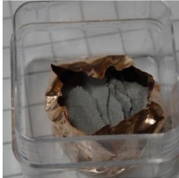
Abbildung 15: Gestapelte MgH<sub>2</sub> Plättchen ohne Cu-Folie als Trägerschicht
