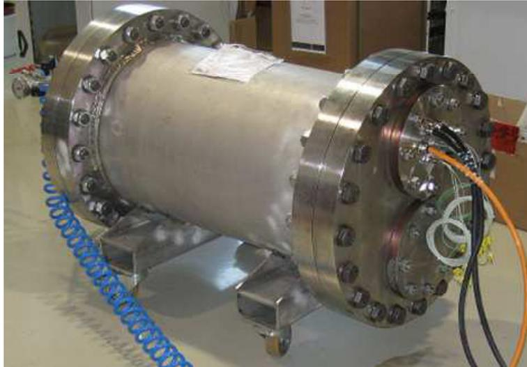
**Abbildung 35 Testsystem mit zylindrischem Druckbehälter**
