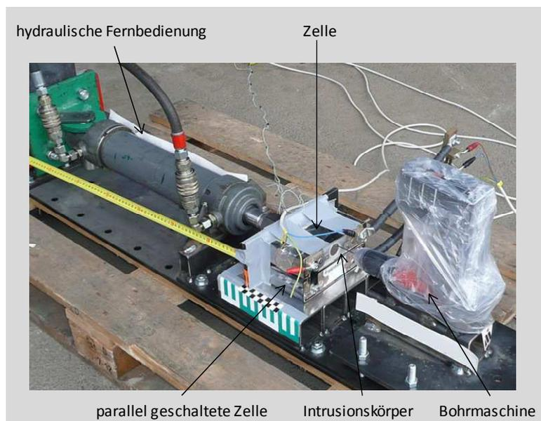
**Abbildung 8 Testsystem zur Provozierung von internen Zellkurzschlüssen**
