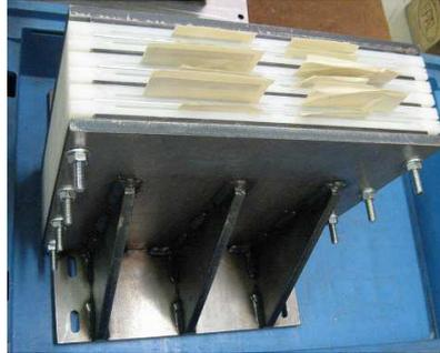
**Abbildung 9 Testmodul – Rahmenkonzept für Pouch-Zellen**
