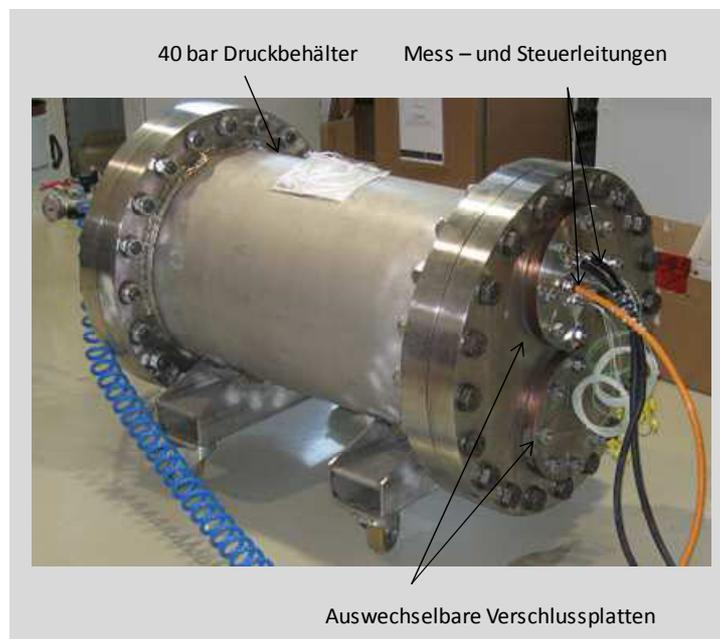
**Abbildung 7 Testsystem mit zylindrischem Druckbehälter**
