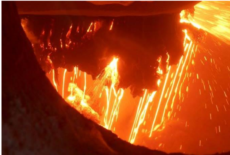
Abbildung 16: Mögliche Auswirkung von Schlackenspritzer am Drehteller
