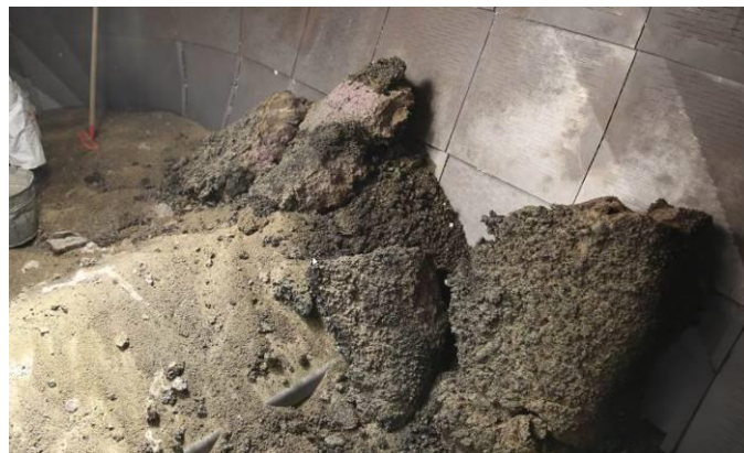
Abbildung 18: Agglomerationsbrocken im Granulator
