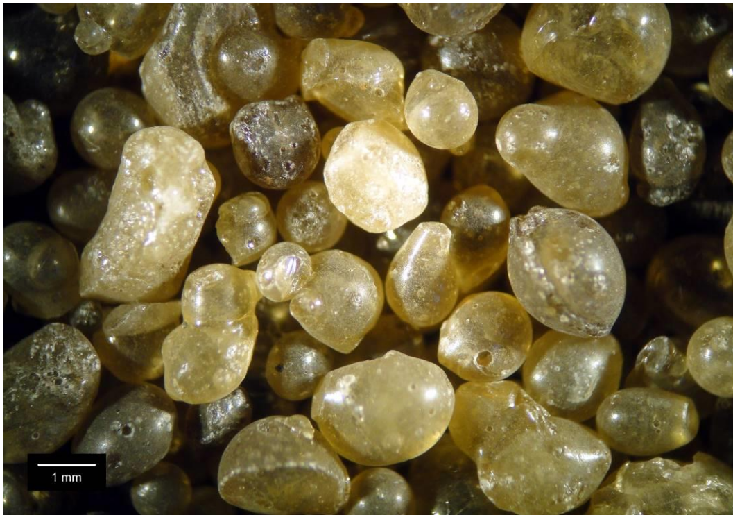
Abbildung 35: Kugelige Anteile 1,0 - 3,15 mm aus Versuch 16
