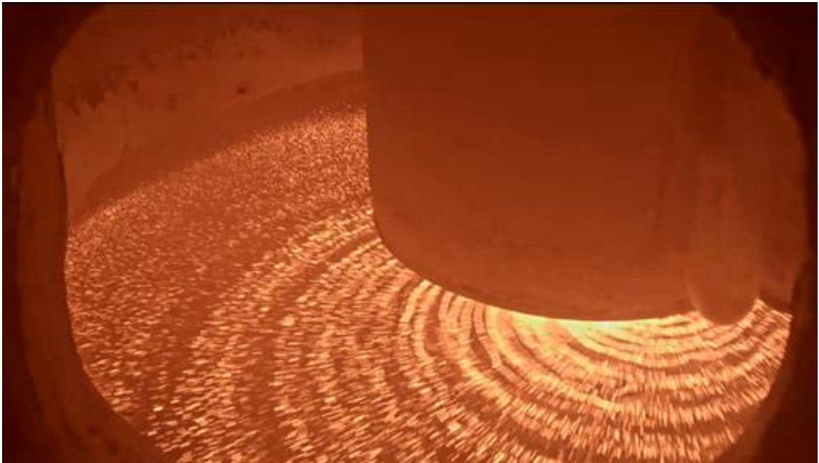
Abbildung 13: Granulationsbetrieb mit der Dry Slag Granulation Anlage bei voestalpine Stahl GmbH
