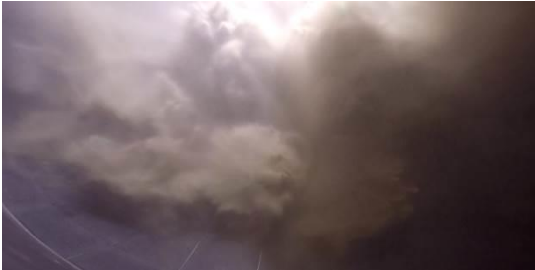
Abbildung 14: Ausgebildete Wirbelschicht im Granulator
