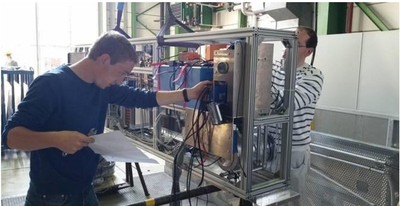
Abbildung 21: Einbau der elektrischen Komponenten in die Konditionierungseinheit im Labor des Institutes für Wärmetechnik
