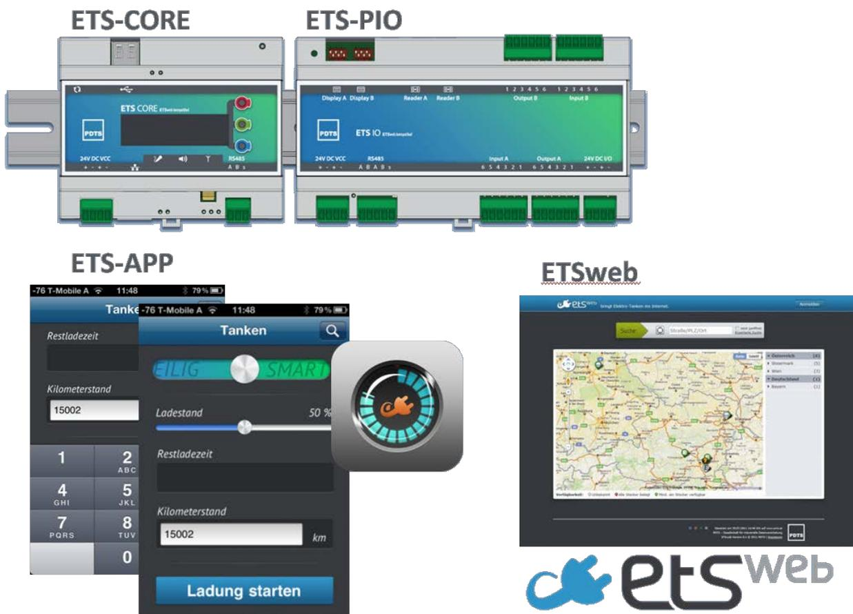
Abbildung 10: Die Komponenten des Gesamtsystems ETS-2010
