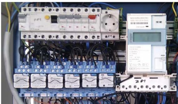
Abbildung 8: Testaufbau der Phasenauswahl-Schaltung mit einem HAGER Smart Meter
