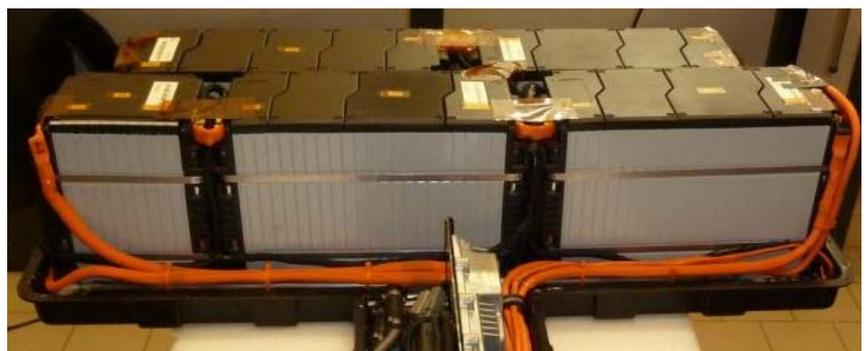
Abb. 9: Batterieaufbau mit Trägerstruktur
