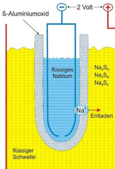
Abbildung 13: Aufbau und Prinzip einer Natrium-Schwefel-Batterie (NaS-Batterie)
