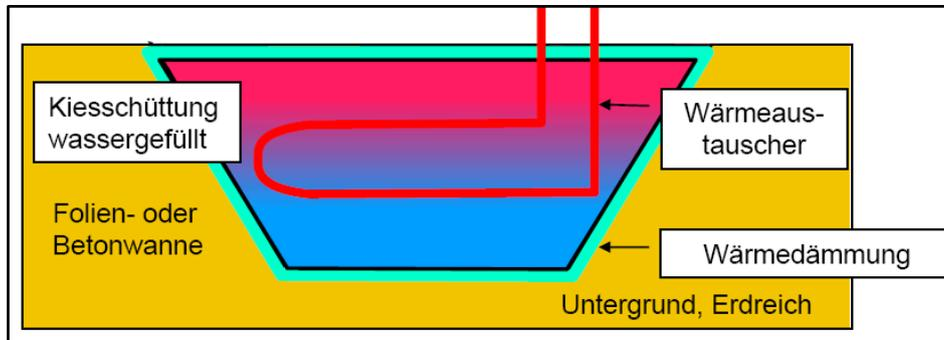
Abbildung 22: Schema Kies-Wasser-Wärmespeicher
