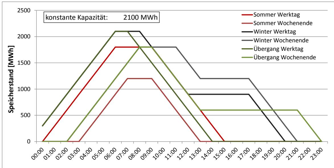
Abbildung 48: Speicherstand bei ertrags-maximierendem Tagesspeicherbetrieb – AA-CAES ( $\eta_{in}=\eta_{out}=84\%$ )
