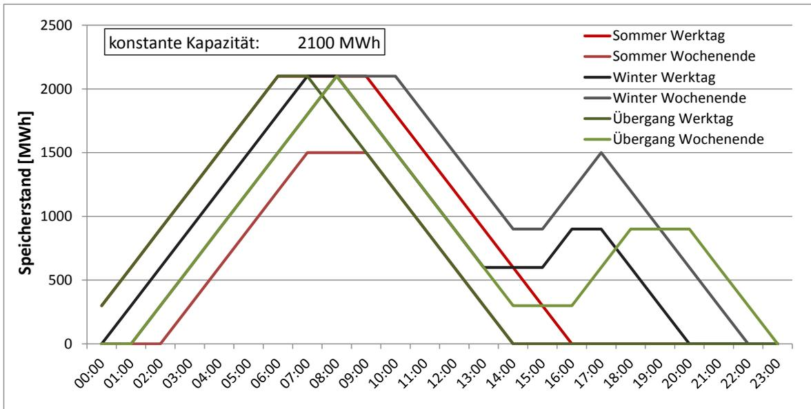
Abbildung 46: Speicherstand bei ertrags-maximierendem Tagesspeicherbetrieb – Pumpspeicher & Li Ionen-Akku ( $\eta_{in}=\eta_{out}=92\%$ )
