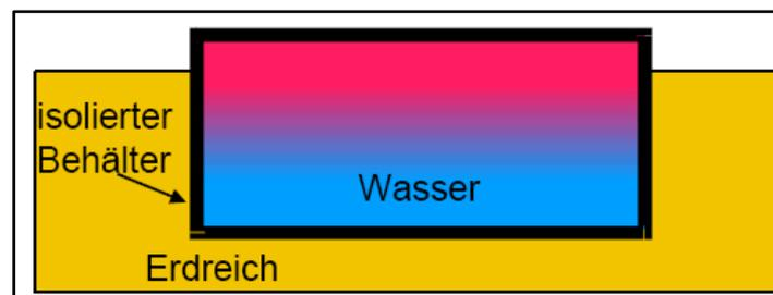
Abbildung 21: Schema Heißwasserspeicher
