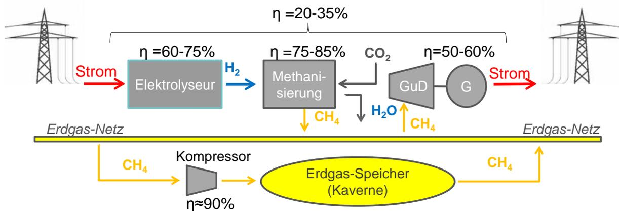
Abbildung 7: Funktionsdiagramm eines EE-CH<sub>4</sub> Speichers
