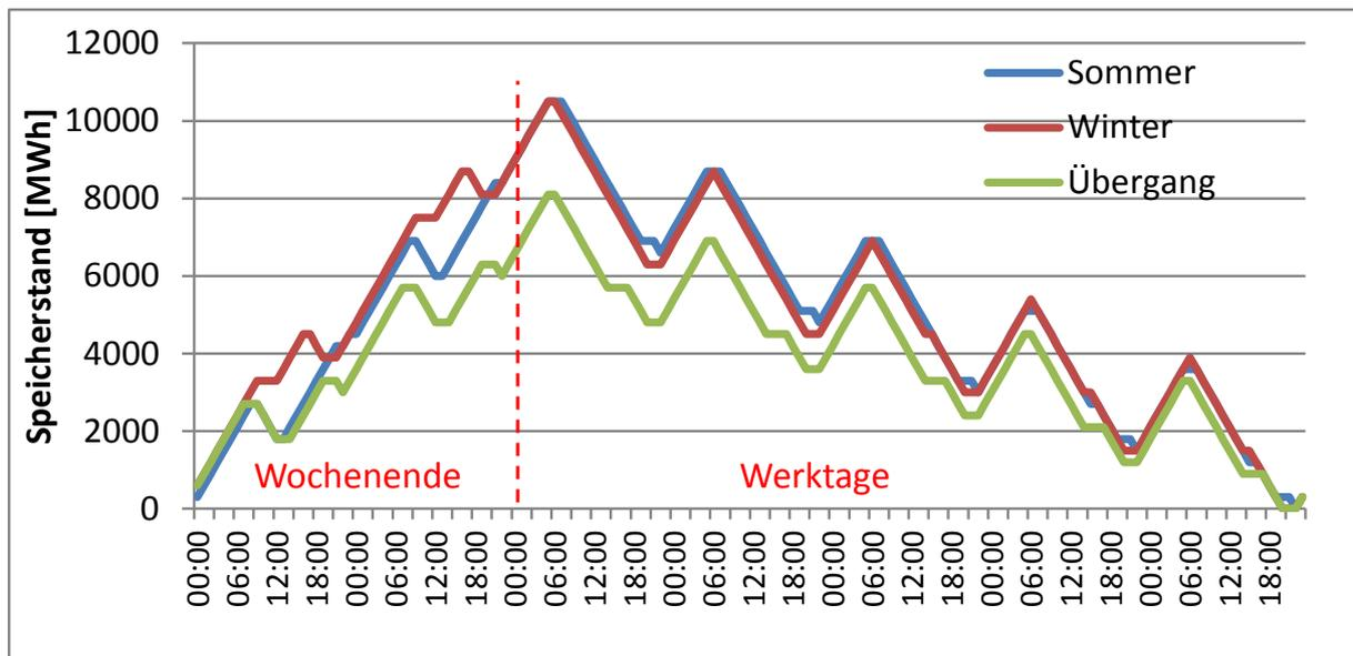
Abbildung 51: Speicherstand bei ertrags-maximierendem Wochenspeicherbetrieb – Pumpspeicher
