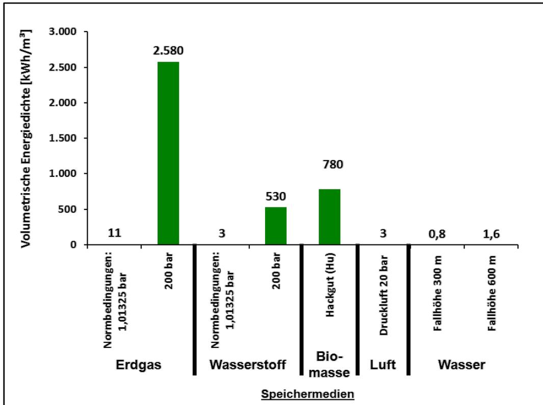
Abbildung 18: Volumetrische Energiedichten von 1 m<sup>3</sup> Brennstoff bzw. der potentiellen Energie von 1 m<sup>3</sup> Speichermedium
