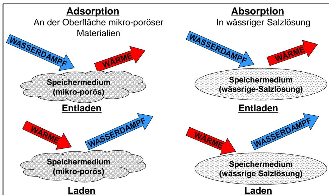
Abbildung 26: Prinzip der Adsorption und Absorption bei Sorptionsspeichern
