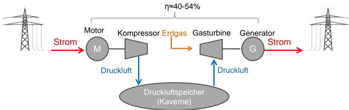
Abbildung 10: Diabater Druckluftspeicher CAES - schematische Darstellung
