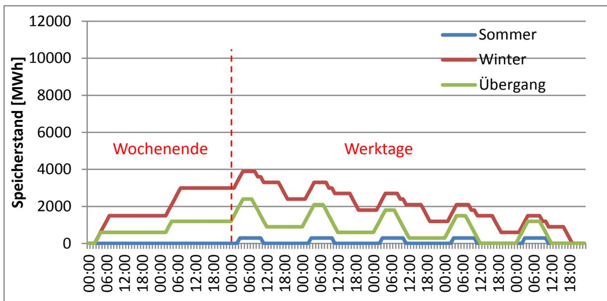
Abbildung 52: Speicherstand bei ertrags-maximierendem Wochenspeicherbetrieb – Wasserstoffspeicher
