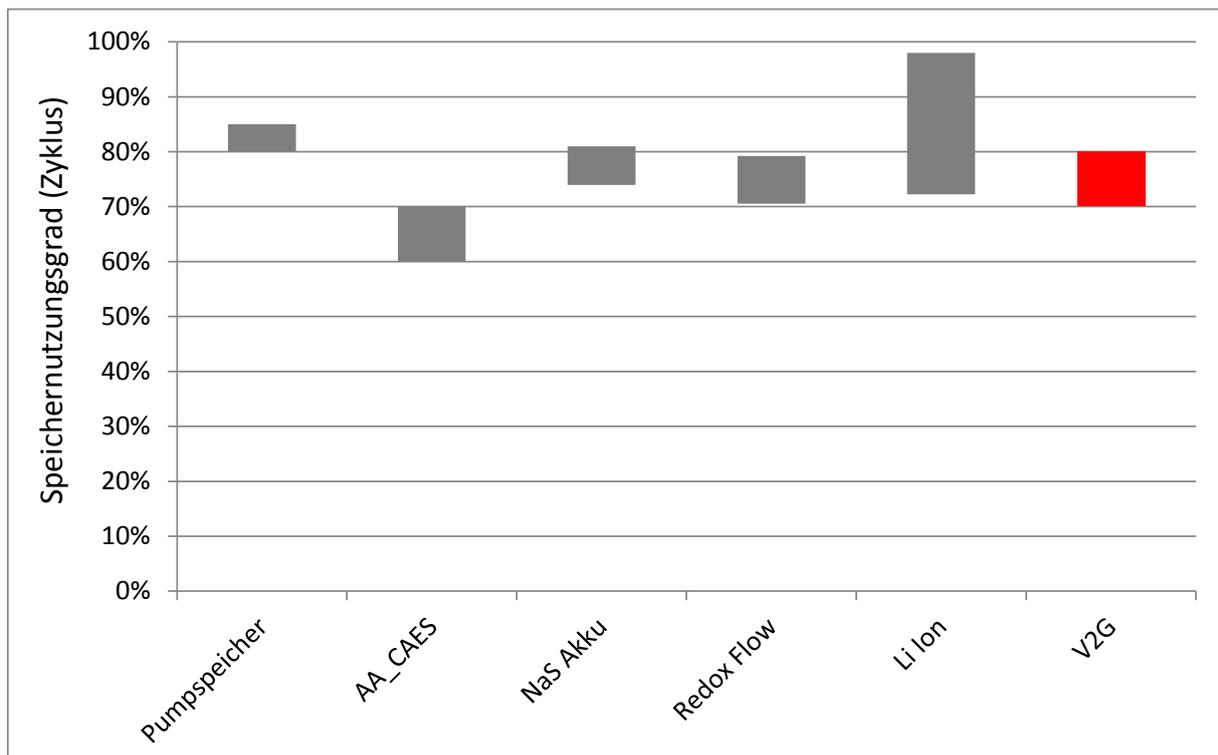
Abbildung 61: Speichernutzungsgrad von Vehicle-to-Grid im Vergleich zu stationären Energiespeichersystemen
