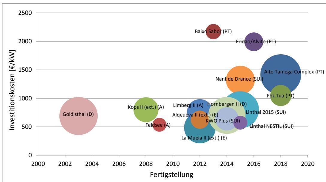
Abbildung 9: Investitionskosten und Leistung internationale Pumpspeicherprojekte (Blasengröße = Leistung)
