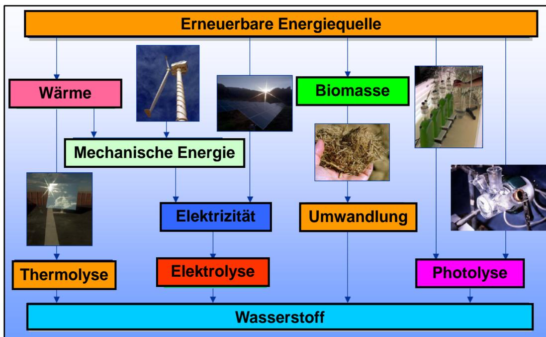
Abbildung 5: Übersicht der Möglichkeiten zur Erzeugung von Wasserstoff aus erneuerbarer Energie
