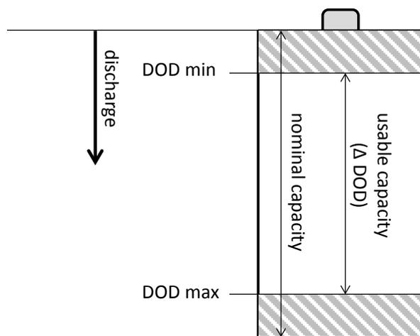
[Abbildung 62](#): Nominelle und nutzbare Kapazität des Akkumulators
