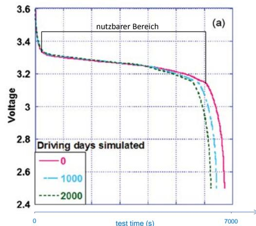
[Abbildung 63](#): Spannungsverlauf einer Li Ionen Zelle bei vollständiger Entladung und unterschiedlicher Zellalterung (adaptiert von Petersson et al. 2010).
