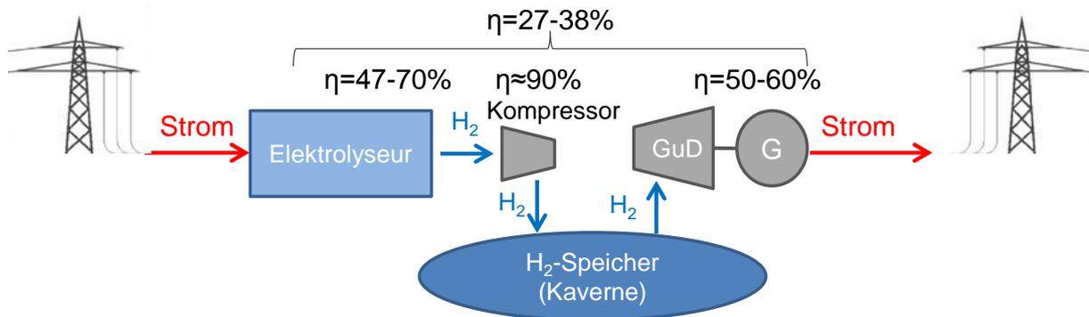
Abbildung 6: Funktionsdiagramm eines Wasserstoffspeichers
