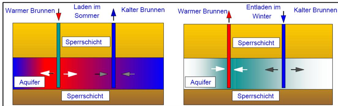
Abbildung 24: Schema Aquiferwärmespeicher
