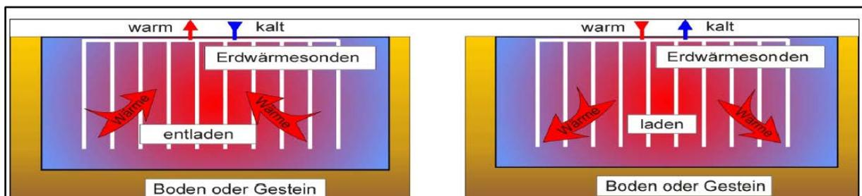
Abbildung 23: Schema Erdsondenwärmespeicher
