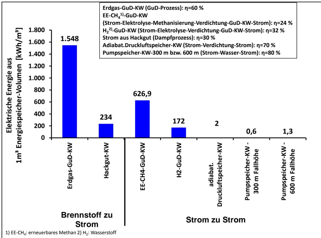
Abbildung 19: Elektrische Energie aus 1 m³ Energiespeicher-Volumen
