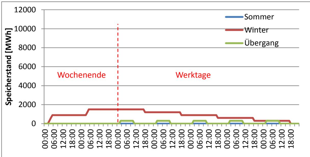
Abbildung 53: Speicherstand bei ertrags-maximierendem Wochenspeicherbetrieb – Methanspeicher
