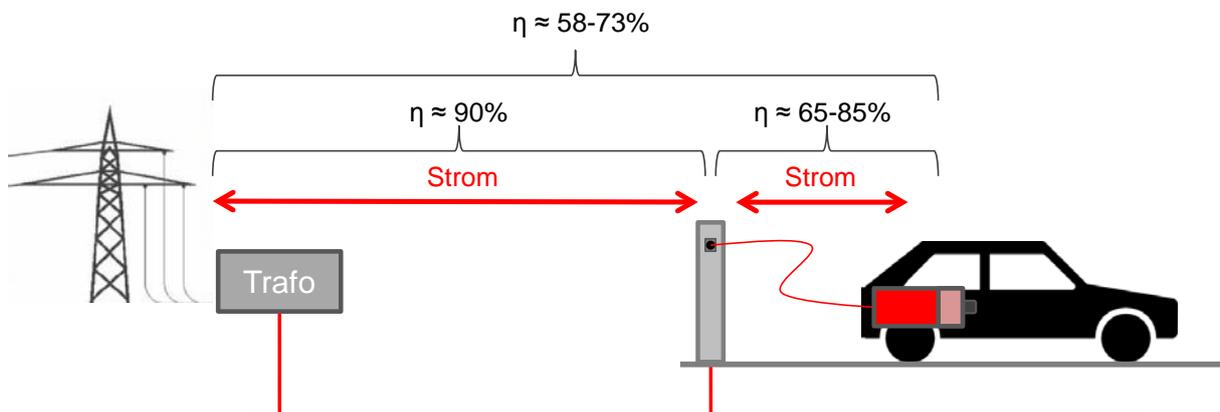
Abbildung 16: Vehicle-to-grid
