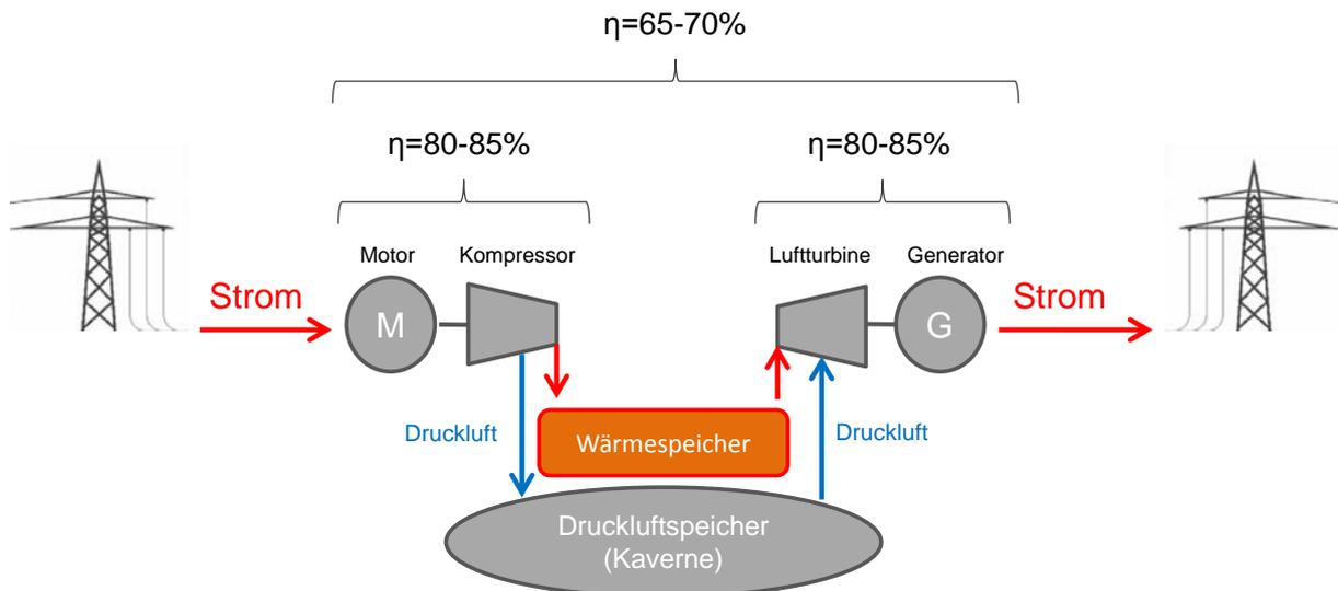
Abbildung 11: Adiabate Druckluftspeicher AA-CAES - schematische Darstellung
