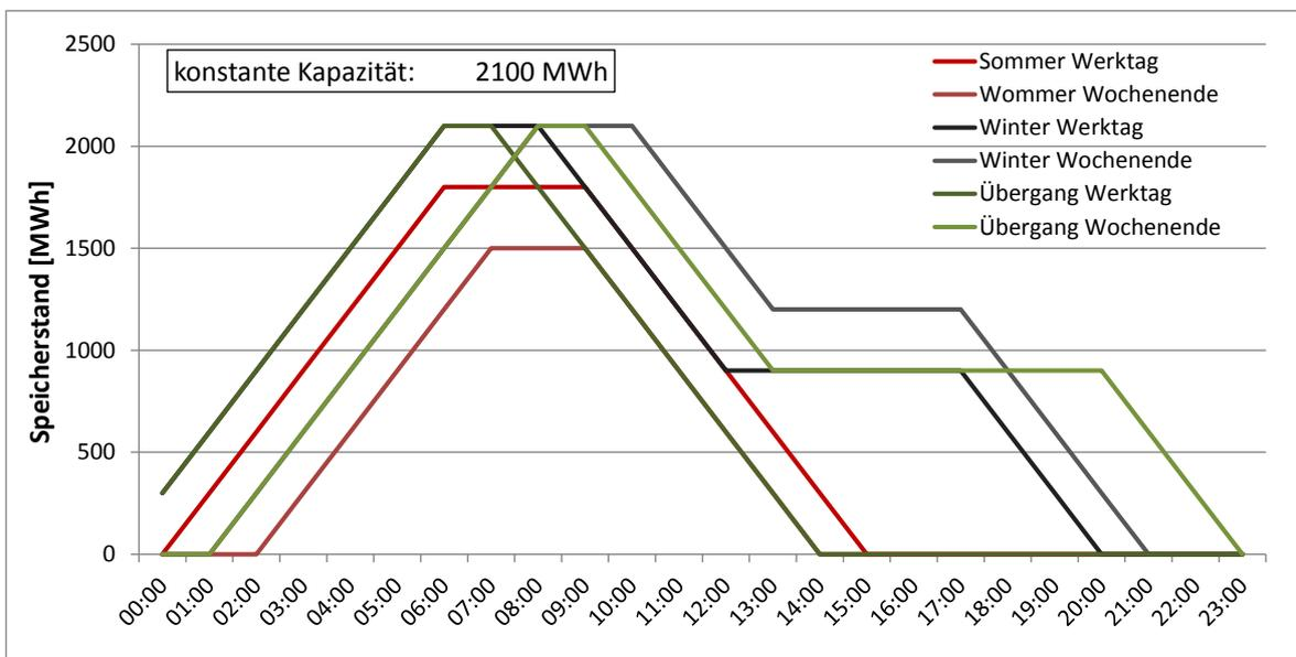
Abbildung 47: Speicherstand bei ertrags-maximierendem Tagesspeicherbetrieb – NaS & Redox Flow ( $\eta_{in}=\eta_{out}=87\%$ )
