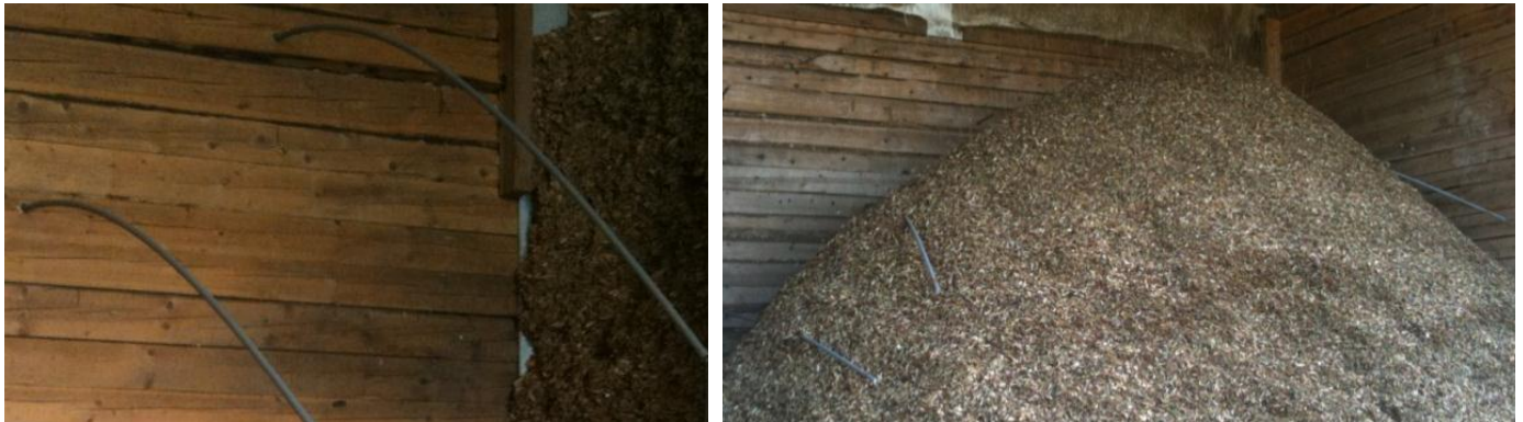
Abbildung 1-3 Anbringung der Messtechnik an der Trockenboxrückwand
