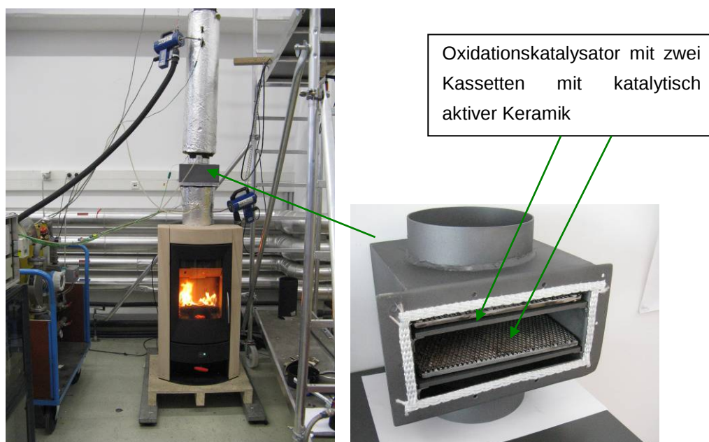
Abbildung 3.15: links: Versuchsaufbau zum Test des Oxidationskatalysators; rechts: Oxidationskatalysator Quelle: Bioenergy2020+
