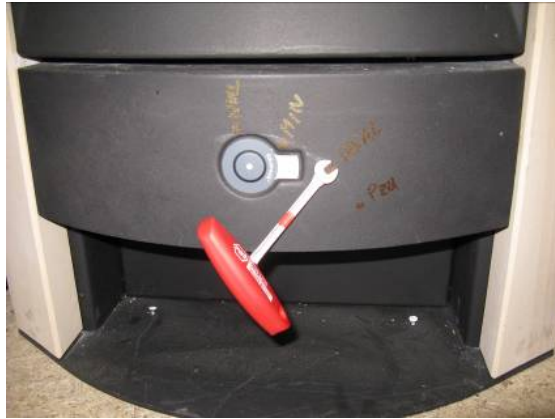
Abbildung 3.13: Verstellbereich bei manuell geregeltem Scheitholzabbrand
