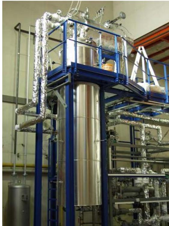
Abbildung 110: Latentwärmespeicherversuchsanlage an der TU Wien [98].
