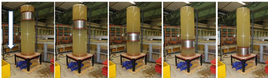
Abb. 3: Modellversuch PT1 mit externer Pumpturbinenanordnung
