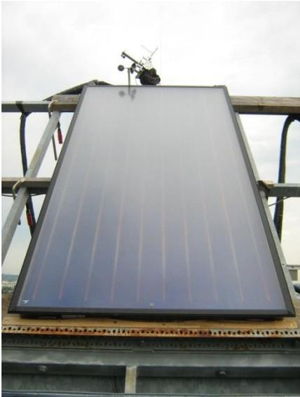
**Abbildung 21: Aufbau Solarkollektor auf dem Prüfstand (Quelle: AIT)**
