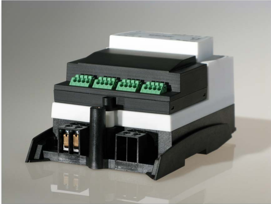
Abbildung 3: Meter-Server ohne Abdeckung. Gut zu erkennen ist das schwarze Schnittstellenmodul, welches über 16 Klemmen (grün) verfügt (3x serielle Schnittstelle und 1xRelais).
