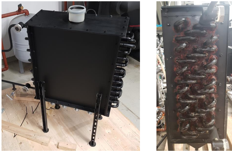
Abbildung 15: Kältemittelgekühlter Abgaswärmeübertrager (Zusammenbau)
