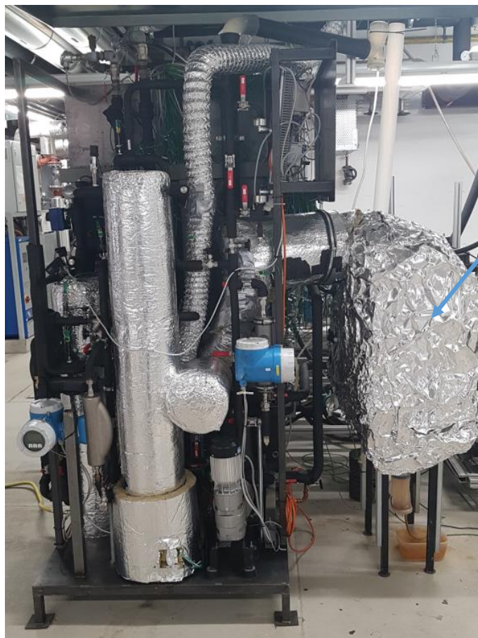
Abbildung 13: Versuchsträger mit kältemittelgekühltem Abgaswärmeübertrager
