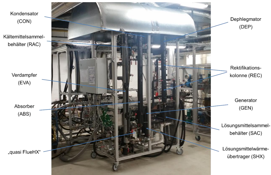
Abbildung 10: Versuchsstand zur Untersuchung der Absorption von „heißem“ Sorptiv
